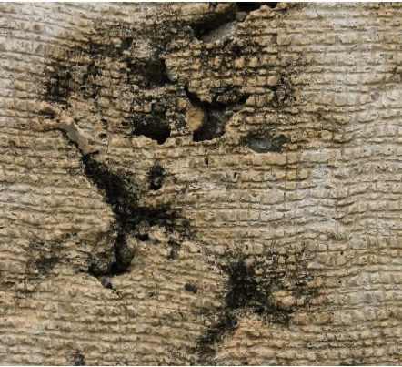
Figura 16. Detalle de depósitos superficiales.
