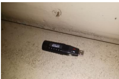
Fig. 20. Medició del l' humitat i temperatura mitjançant el Datalogger LOG32®. Font: L. Mañez (2016).
