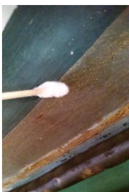
Fig. 22. Rodat amb hisop de cotó, impregnat amb una de les mescles del test de Wolbers. Font: L. Mañez (2016).
