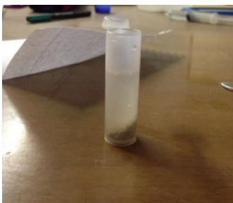
Fig. 18. Dissolució morter de guix i aigua destil·lada. Font: L. Mañez (2016).
