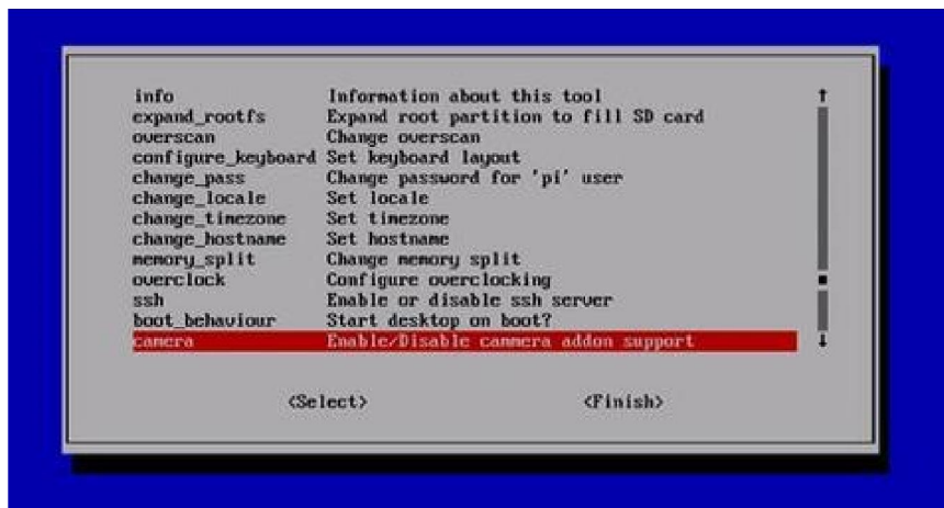
Figura 18 - Activación del módulo de cámara
