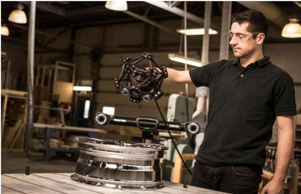
**Ilustración 41** Escaneado 3D con MetraSCAN. Fuente: [www.directindustry.es](http://www.directindustry.es)
