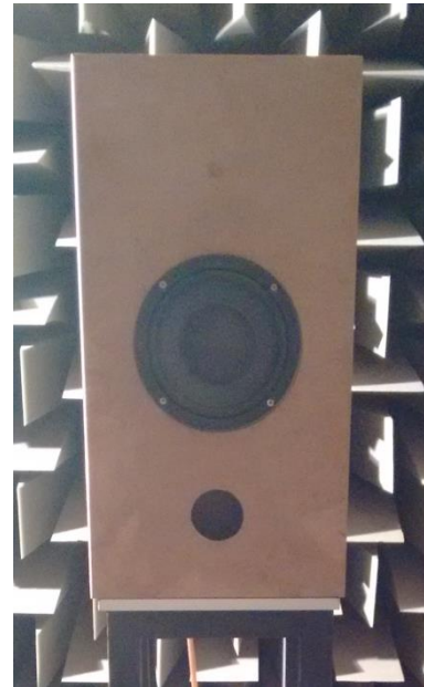
Figura 20: Caixa tancada remodelada a bass-reflex
