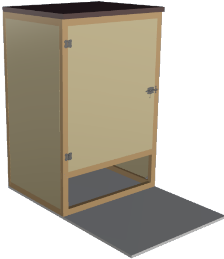
Vista del módulo con la estructura, revestimiento, encimera, baldas y puertas
