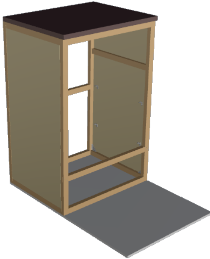
Vista del módulo con la estructura, revestimiento y encimera
