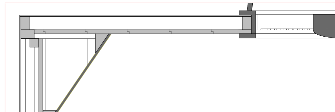
SECCIÓN - Conjunto con embellecedor y elementos pre-aislamiento
