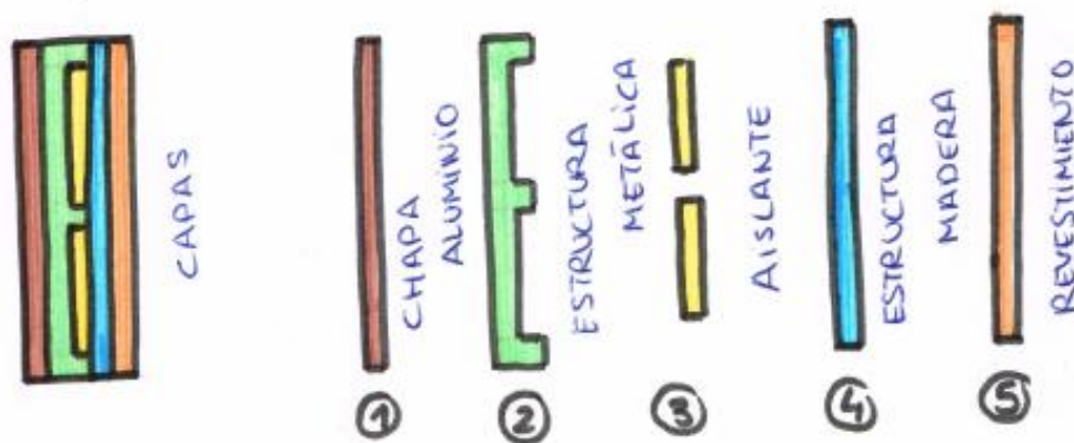
Capas del aislamiento de las paredes, puertas y techo
