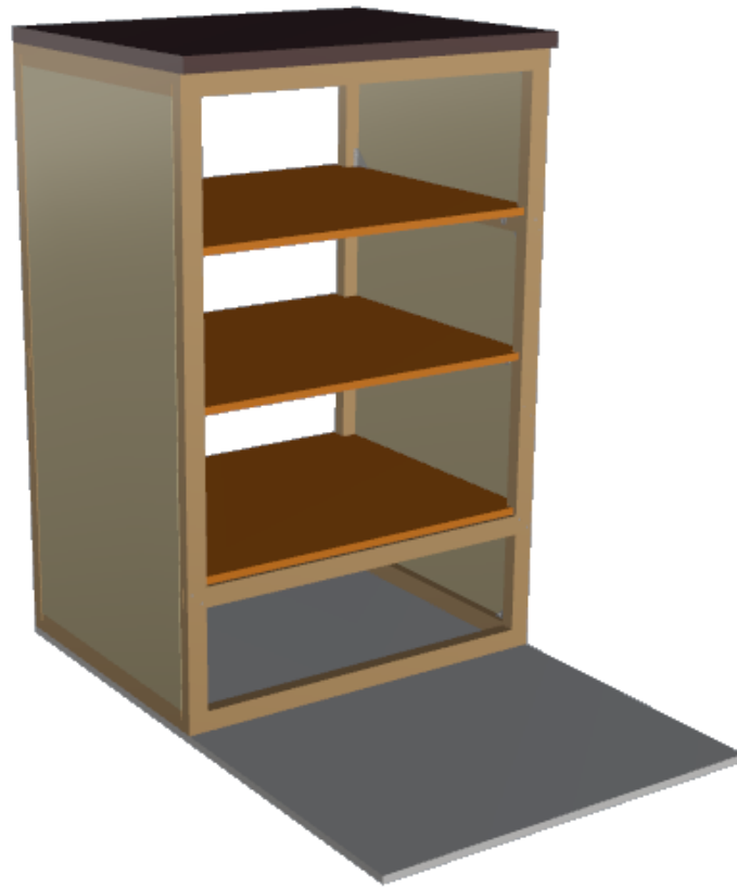
Vista del módulo con la estructura, revestimiento, encimera y baldas
