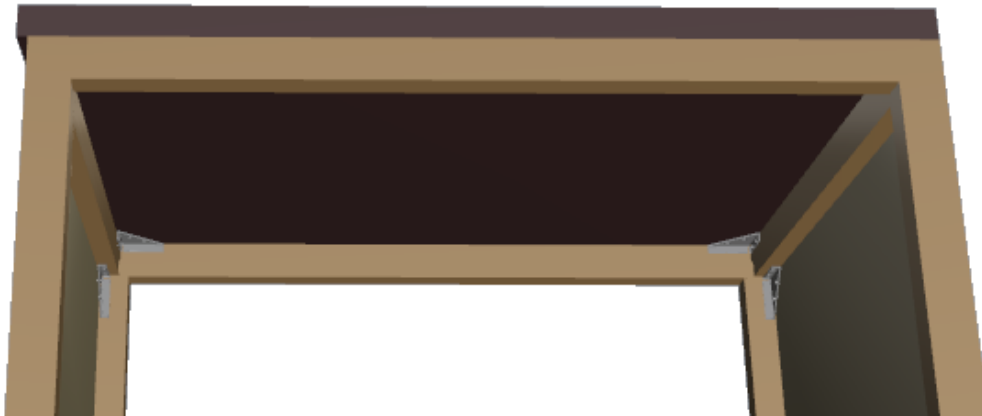
Vista detallada de la unión de la encimera a la estructura
