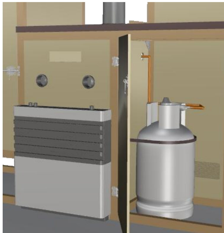
Vista de detalle situación de la bombona de la estufa
