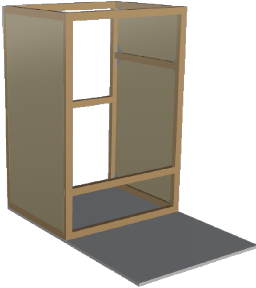
Vista del módulo con la estructura y el revestimiento lateral
