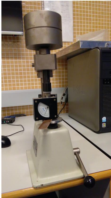
Figura 4.12: Medición de dureza sobre probeta de yute.
