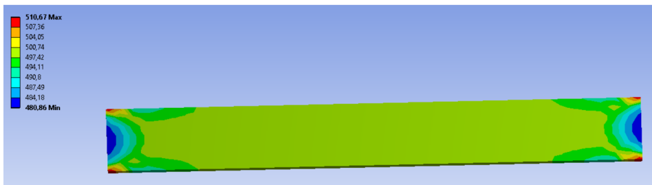
Figura 5.18: Tensión de rotura.
