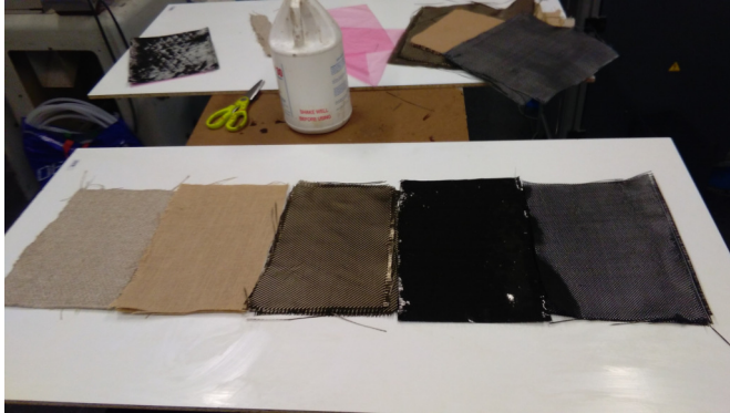
Figura 3.20: Proceso de fabricación. Posicionamiento de tejidos.
