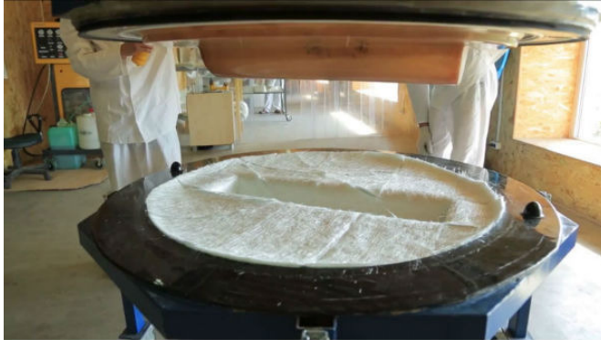
Figura 1.9: Fabricación de un componente por método de moldeo RTM en molde cerrado.
