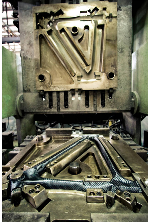
Figura 1.8: Moldeo por compresión en caliente del bastidor de una bicicleta de fibra de carbono.
