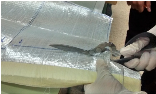
Figura 3.19: Proceso de fabricación. Corte de tejidos.
