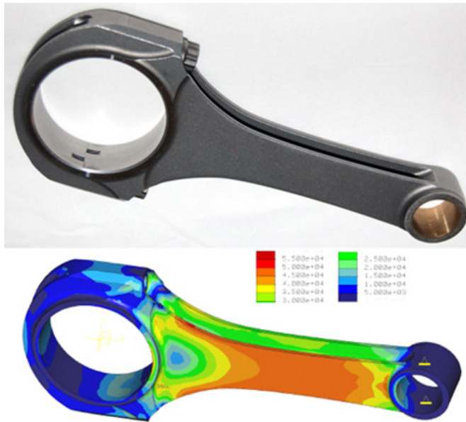
Figura 5.6: Simulación FEM de una biela.
