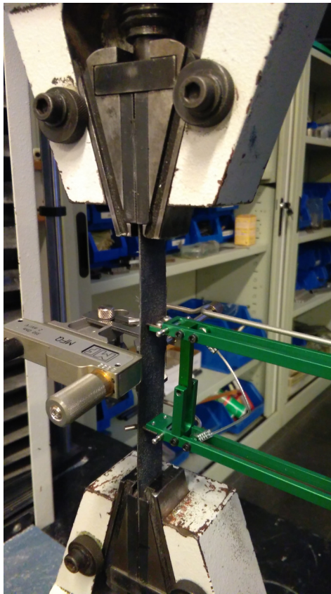
Figura 4.4: Montaje de extensometro. Ensayo Poisson.
