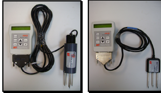
Figura 28. Theta probe ML2x y Wet-2 (de izquierda a derecha)
