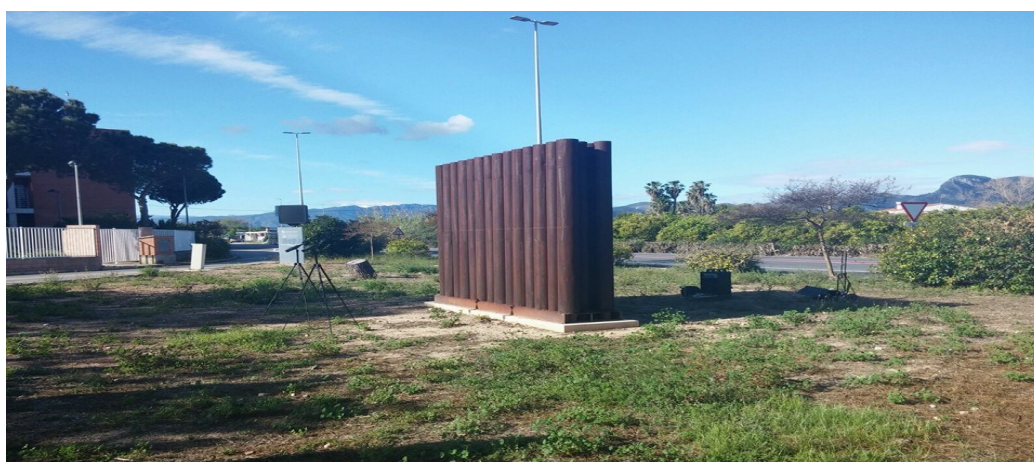
Figura 7. Pantalla acústica basada en cristales de sonido situada en el Campus de Gandia.
