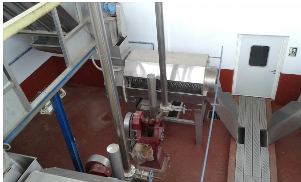
Figs. 24 y 25 Máquina estrujadora-despalilladora Bodega El Villar
