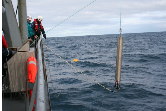
Figura 2. Hidrófono siendo sumergido en el mar
