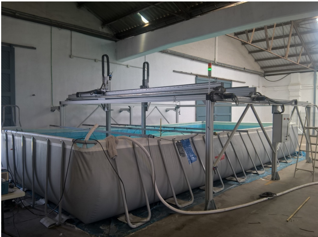
Figura 18. Piscina del Puerto de Gandía con ejes motorizados
