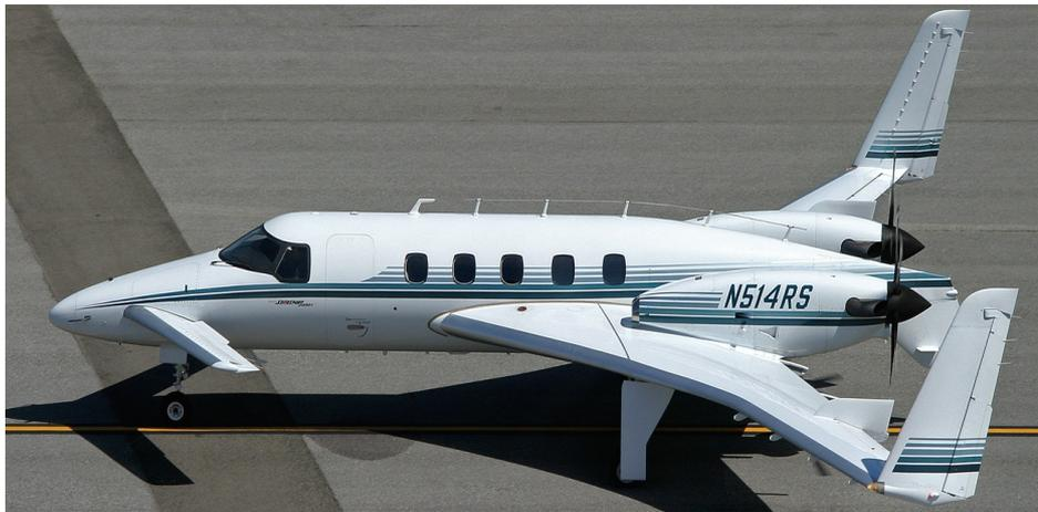
Figura 1.5: Beech Starship I, diseñado por Burt Rutan, primer avión comercial con una estructura completamente de materiales compuestos en obtener la certificación de la FAA [22].
