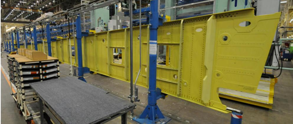
Figura 1.2: Larguero central del ala de un Boeing 747-8, ejemplo de viga armada bajo tensión diagonal [19].
