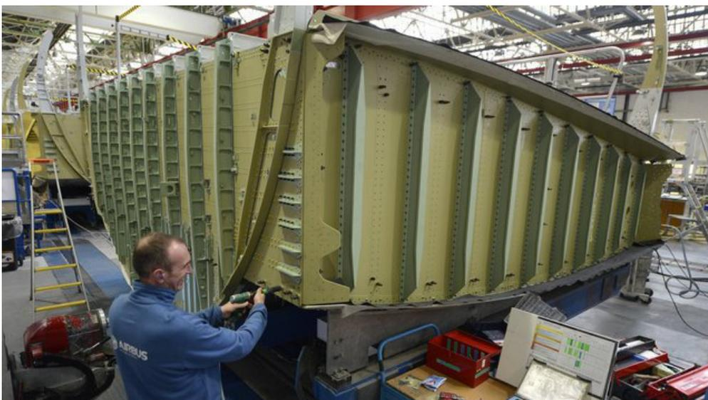
Figura 1.3: Cajón de torsión central ('central wing box') de un Airbus A320 [21].
