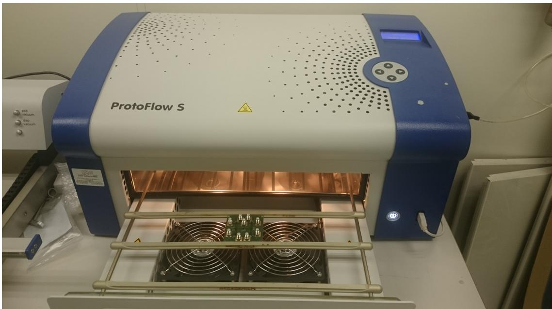
**Figura 4.5:** Fotografía tomada tras la finalización del procesado de soldadura en el horno
