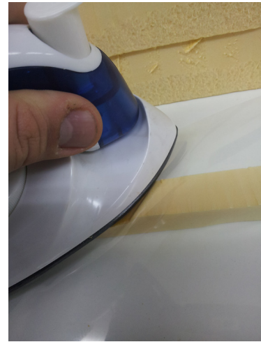
FOTO 207. PRUBA DE CALOR EN LA PLANCHA DE POLIESTIRENO EXTRUIDO
