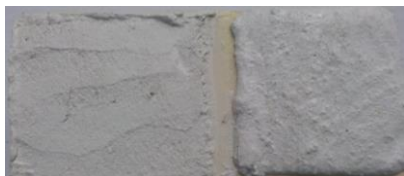
Figura 49. Probeta de morteros: 1:3 Cal + Arena + 10% PVA (Izquierda); 1:3 Cal + Arena (Derecha)
