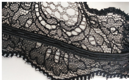
IMAGEN 35. Cosido de cinta elástica a encaje.
