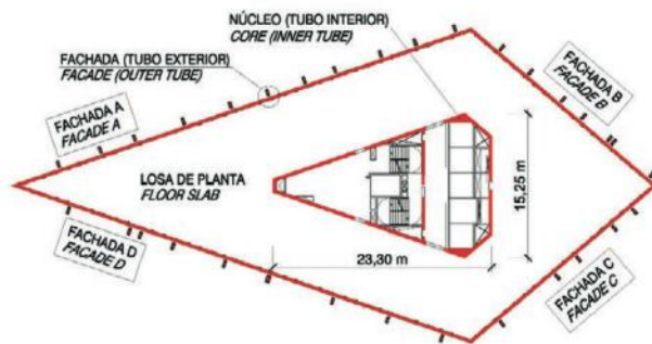
Imagen 3.1.1. Esquema del funcionamiento estructural
