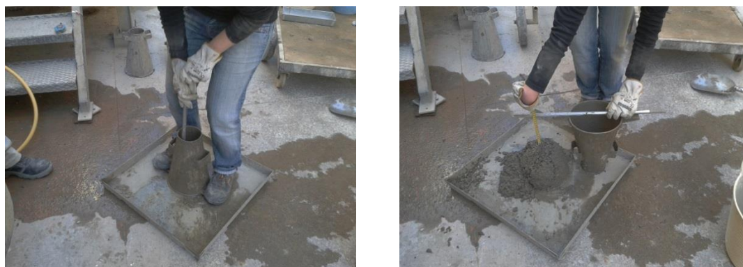
Fig. 3-6 - Slump test following UNE EN 12350-2:2009.
