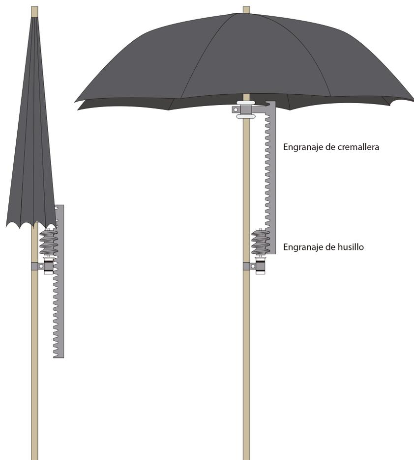
Figura 54. *Boceto sistema apertura con engranajes*
