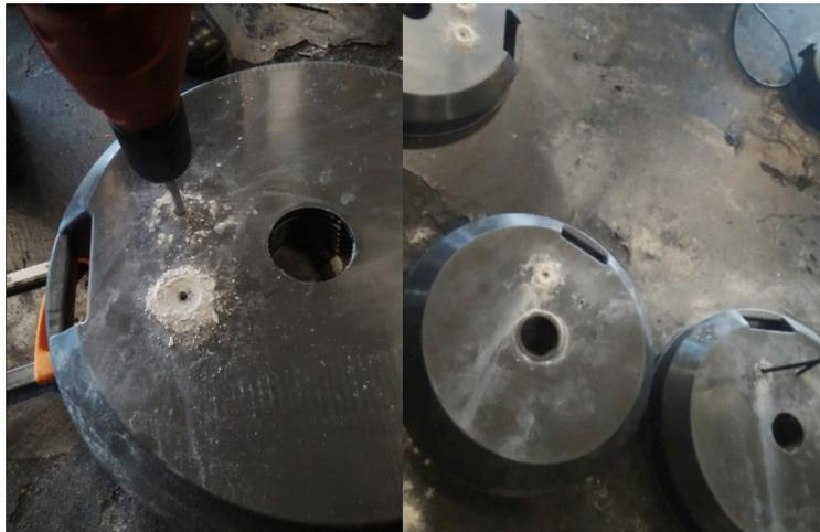
Figura 56. Perforando bases de los parasoles
