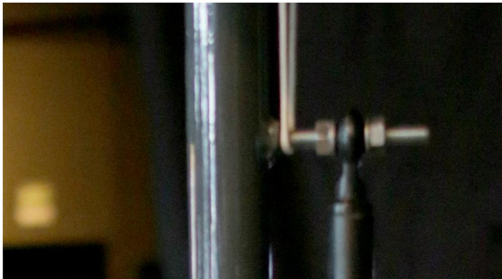
Figura 61. *Apéndice del actuador lineal con varilla roscada*
