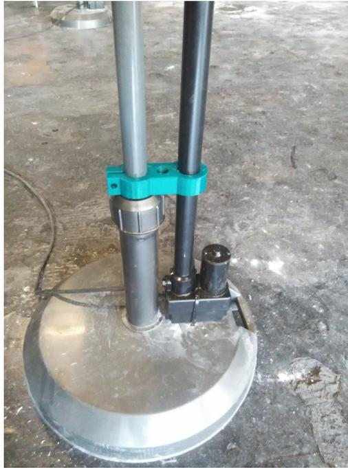
Figura 58. Pieza de sujeción colocada
