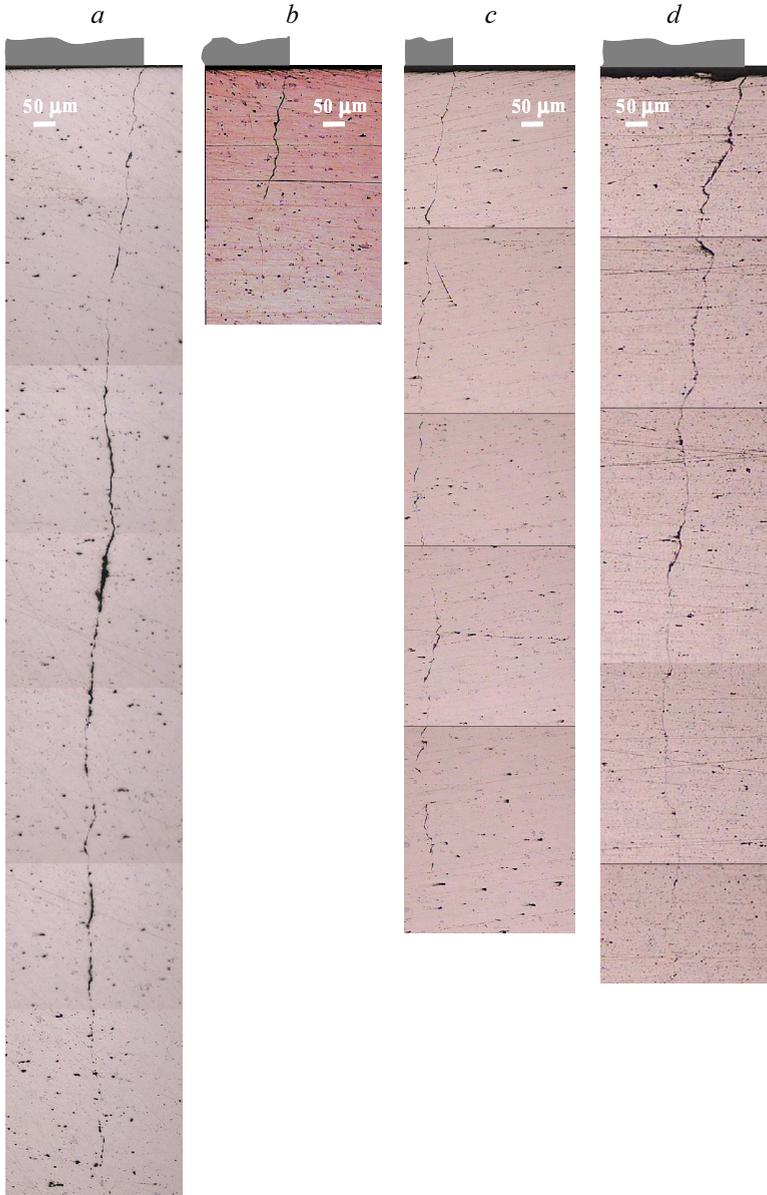
FIGURA 5.32: Micrografías de las probetas correspondientes a los ensayos 1, 5, 8 y 15 de la Tabla 5.2. Como referencia, la longitud total de la grieta mostrada a la izquierda es aproximadamente 2 mm
