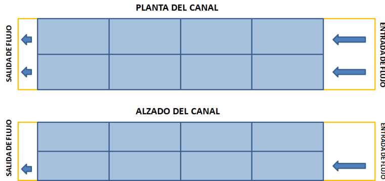
Figura 21. Distribución en planta y alzado de Aquacells para la configuración 2x2x4.
