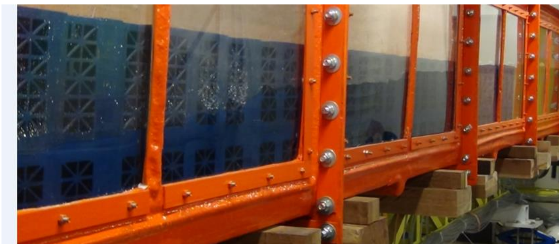
Figura 25. Vista lateral del canal de laboratorio con perfil del flujo a lo largo de los elementos modulares.
