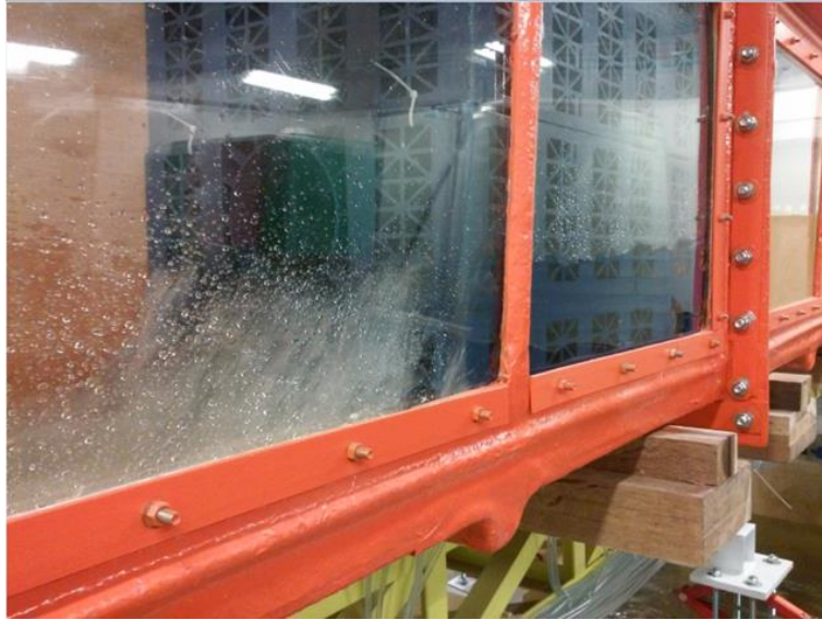
Figura 26. Vista de la salida del flujo del último Aquacell en canal de laboratorio para un caudal elevado.
