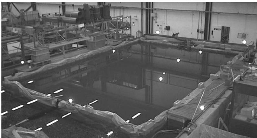
Figura 8.- Modelo del tanque de retención de laboratorio (Adamsson et al., 2005).
