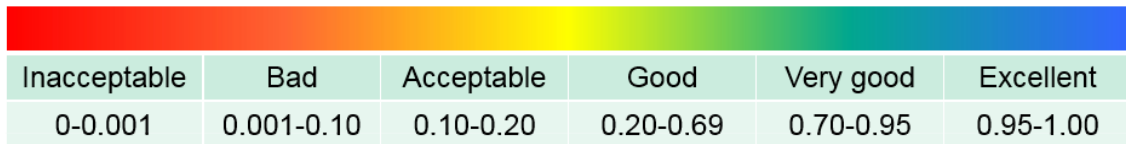
Figura 57. Espectro del índice de calidad ortogonal (OQ) (ANSYS Meshing User's Guide, 2012).
