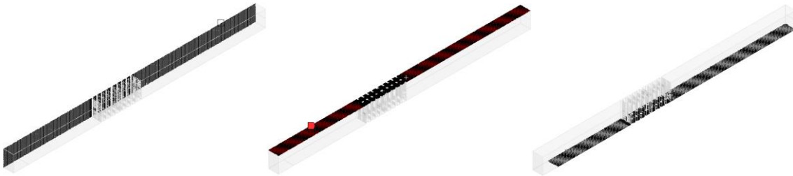
Figura 62 , Figura 63 y Figura 64. Zonas del modelo correspondientes a las condiciones de contorno “lateral, techo y suelo”.
