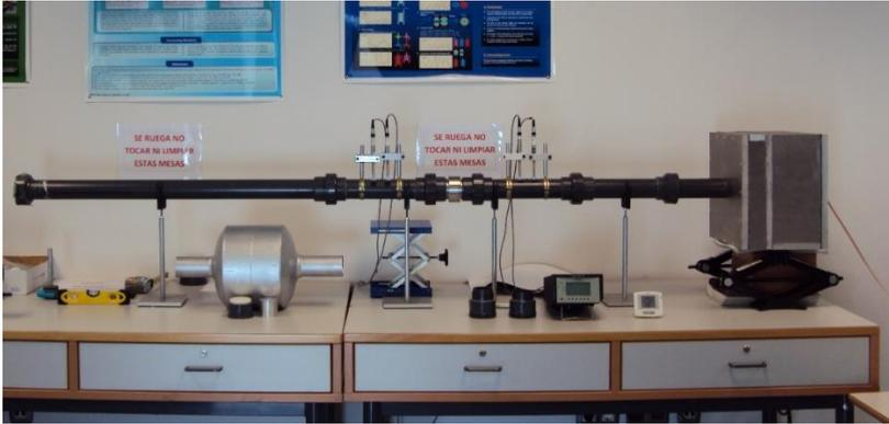
Figura 3.2: Configuración experimental para superficies sinterizadas por medio del método de la matriz de transferencia
