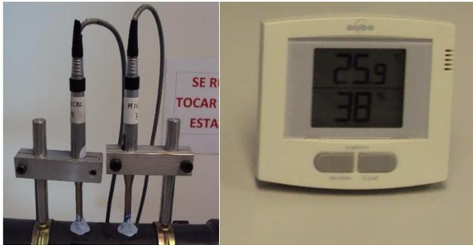
Figura 3.5 Micrófonos de Presión (izquierda). Estación Meteorológica (derecha)
