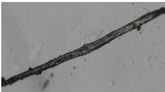
Fig.30. Microfotografía de la sección longitudinal de la fibra de la banda derecha. Luz transmitida. X150
