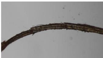
Fig.31. Microfotografía de la sección longitudinal de la fibra de la tela original. Luz transmitida. X150
