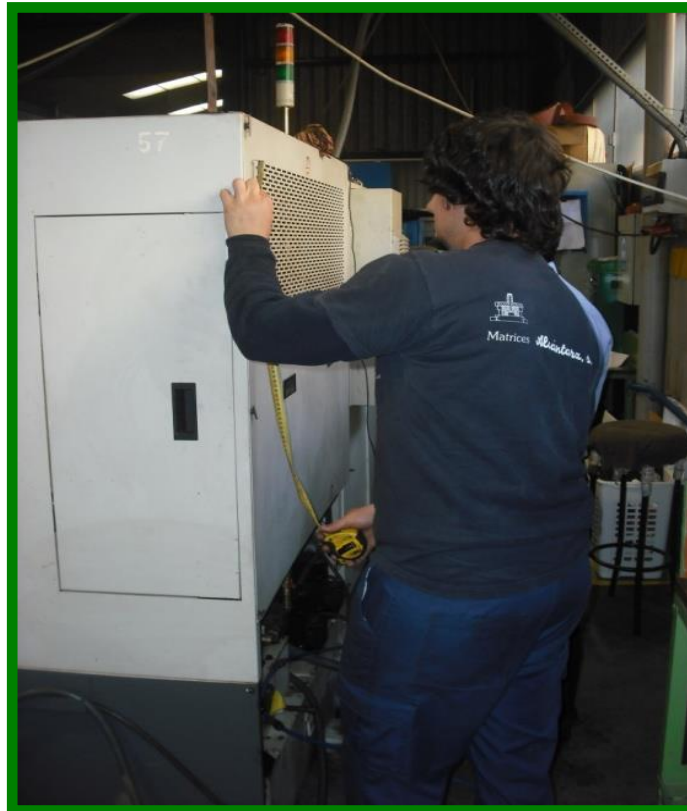
Fig 9. Realizando aberturas para facilitar la inspección al operario
