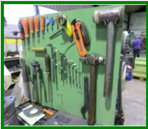
Fig 20. Cuadro con lo necesario para el cambio rápido de herramienta.
