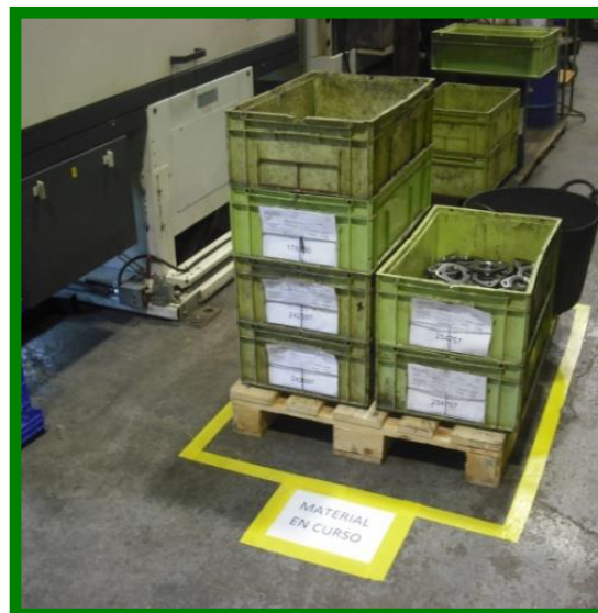
Fig 10. Zona de material en proceso
