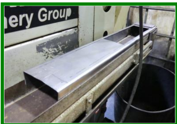
Fig 17. Canalización en cinta transportadora para evitar proyecciones de ferricha y la contaminación del entorno
