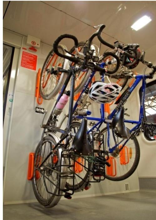
*Imagen 109. Portabicicletas con capacidad para 4 bicicletas. Un hándicap que se observa es que hay poco espacio entre ellas, 2015*
