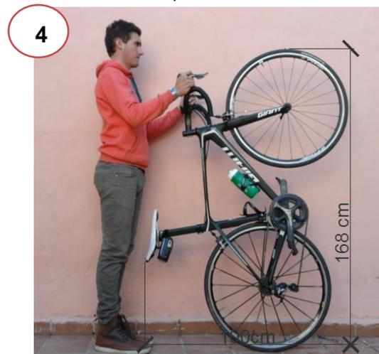
Imagen 179. Usuario colocando la bicicleta en disposición vertical para introducirlo en el portabicicletas del vagón.
