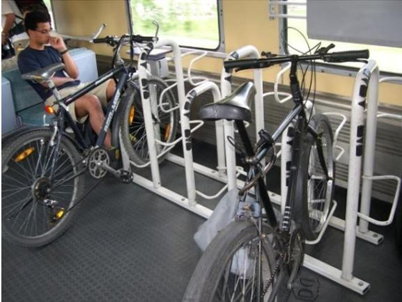
*Imagen 120. Perfiles de tubo redondeado de aro envolvente donde se introduce la rueda delantera a la que está sujeta por ambos lados, 2015*
