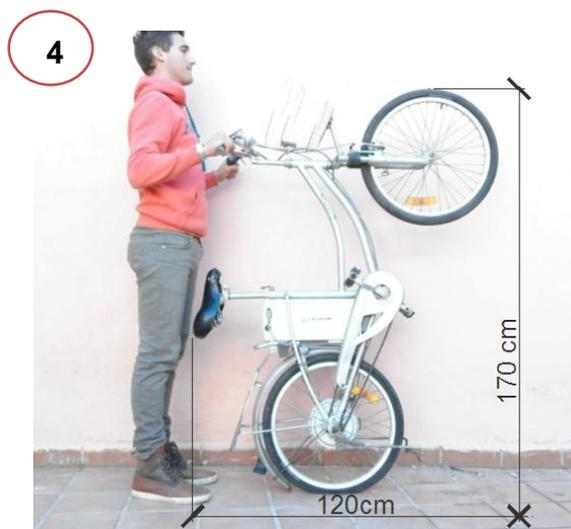
Imagen 185. Usuario colocando la bicicleta en disposición vertical para introducirlo en el portabicicletas del vagón.
