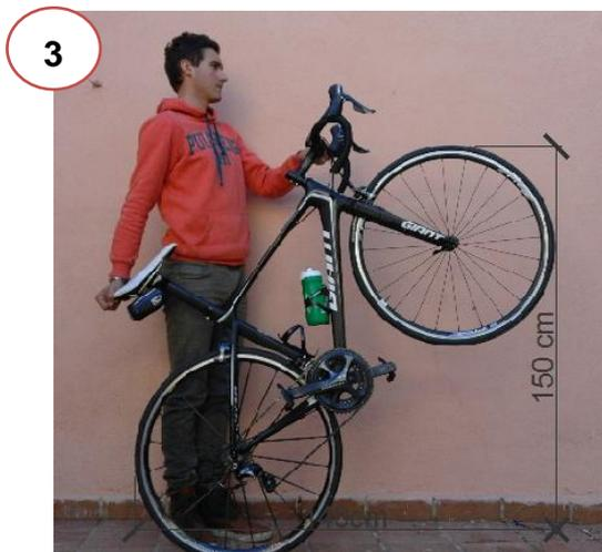
Imagen 178. Inclinación de la bicicleta a 45° aproximadamente para su correcta colocación.
