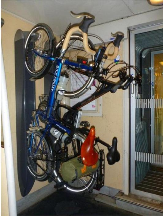
*Imagen 112. Bastidor longitudinal que soporta ambas ruedas para reducir la oscilación y daños de la bicicleta, 2012*
