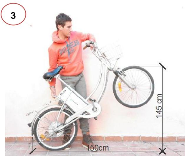
Imagen 184. Inclinación de la bicicleta a 45° aproximadamente para su correcta colocación.
