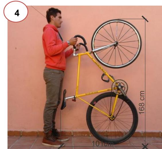
Imagen 173. Usuario colocando la bicicleta en disposición vertical para introducirlo en el portabicicletas del vagón.
