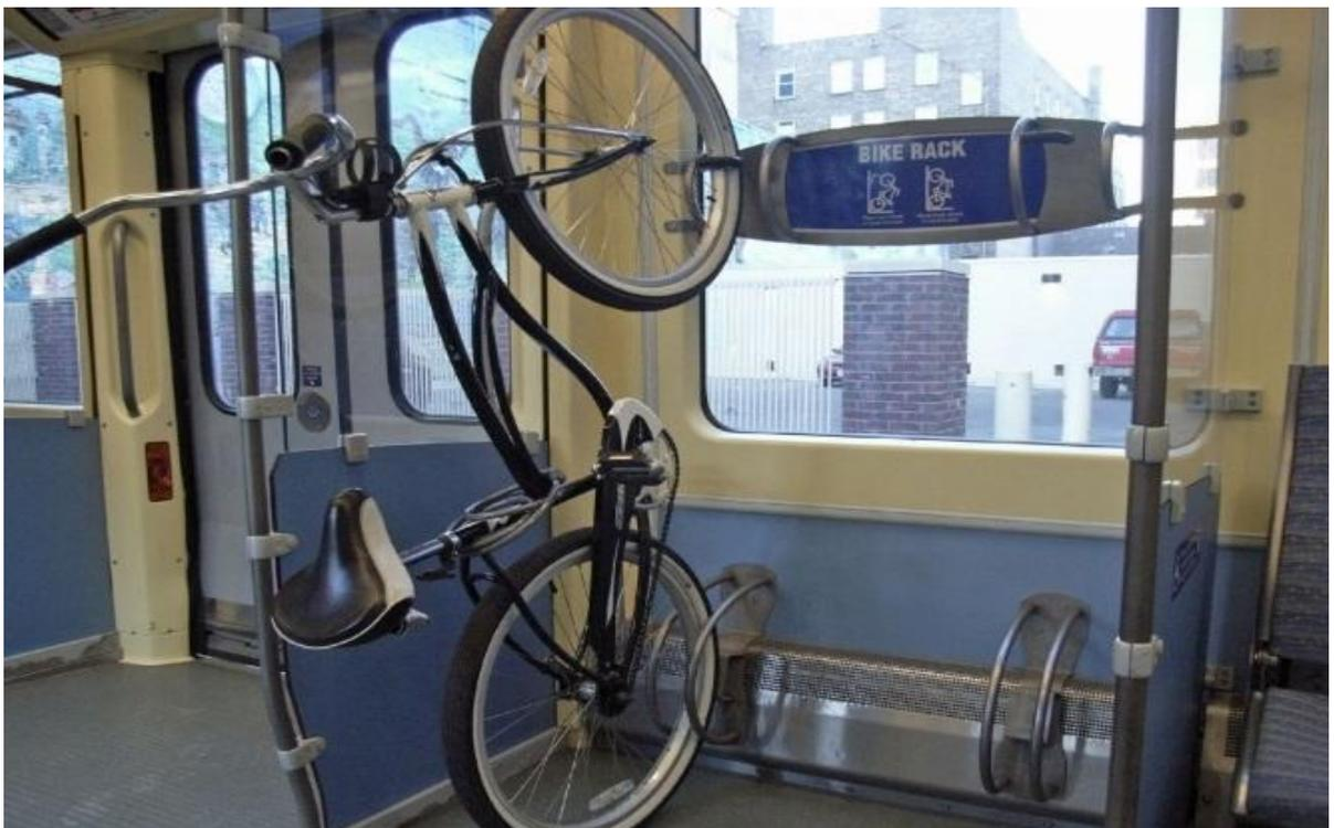
Imagen 66. Portabicicletas para su disposición en Vertical, 2014
