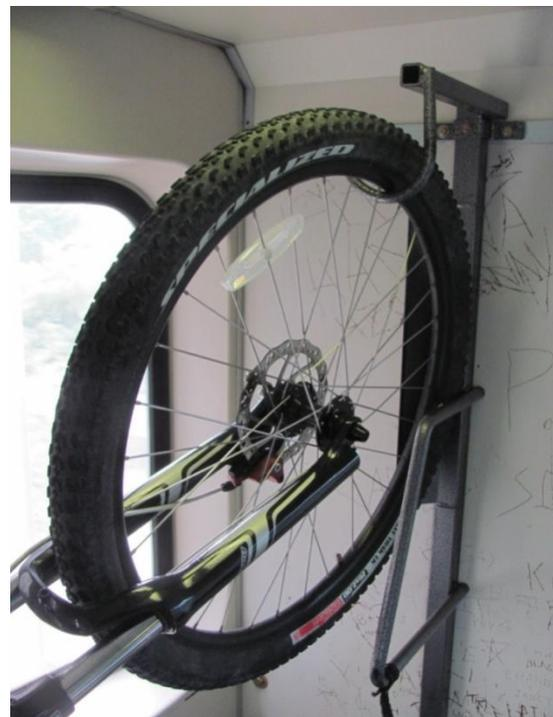
*Imagen 111. Enganche de gancho. La ventaja observada es que hay un bastidor lateral para impedir la oscilación de la bicicleta, 2014*
