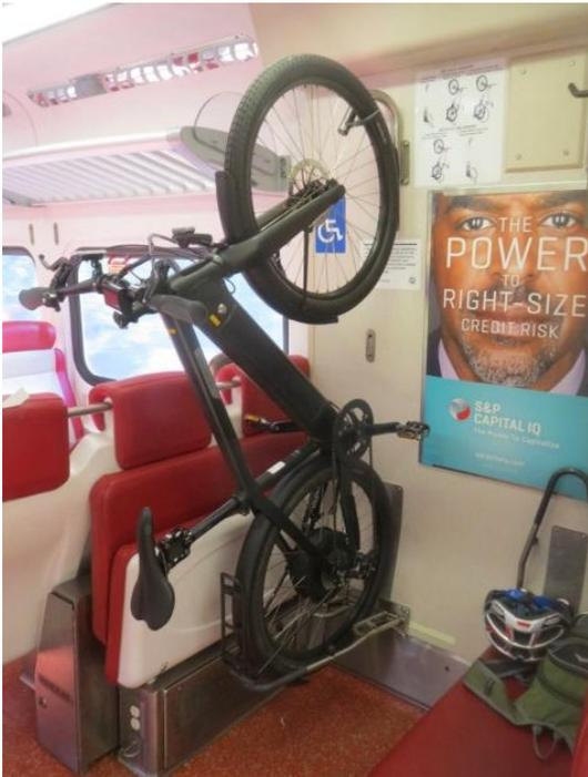
*Imagen 108. Soporte de la rueda trasera para una mejor sujeción. Un hándicap es que hay que elevarla del suelo, 2014*
