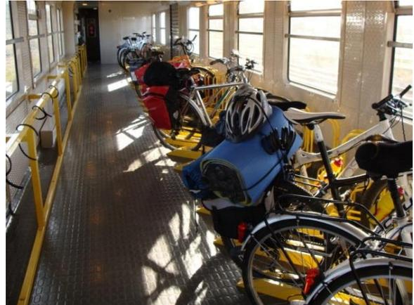
*Imagen 121. Vagón específico para bicicletas. Disposición en batería y alberga zona de portabicicletas y paralelamente un pasillo corredor para el paso de los pasajeros, 2015*
