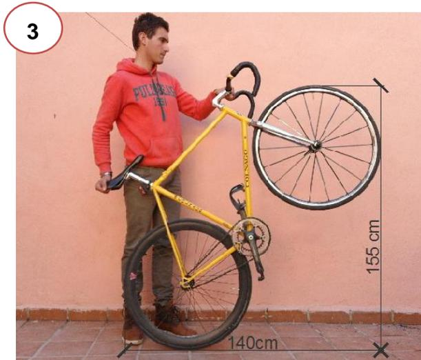
Imagen 172. Inclinación de la bicicleta a 45° aproximadamente para su correcta colocación.
