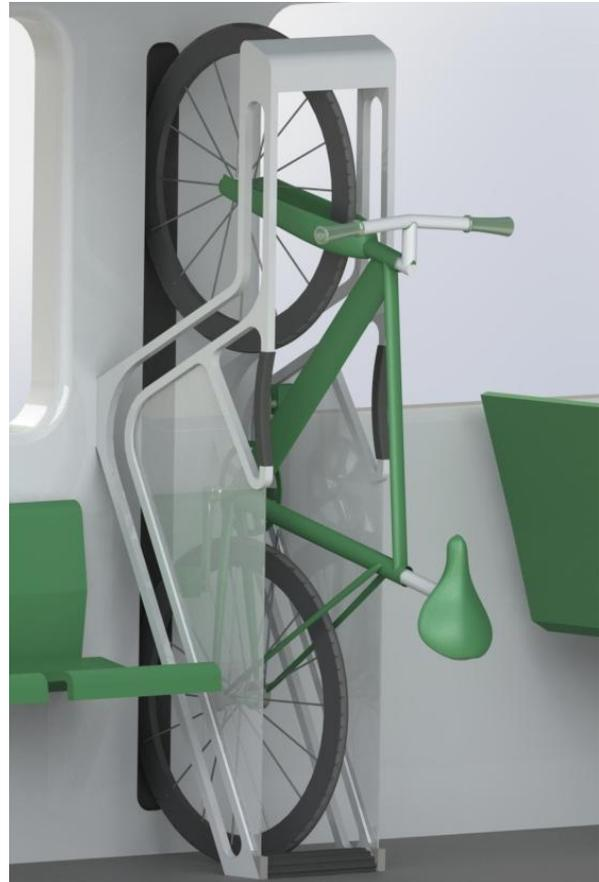
*Imagen 206. Portabicicletas integrado en el vagón de tren.*
