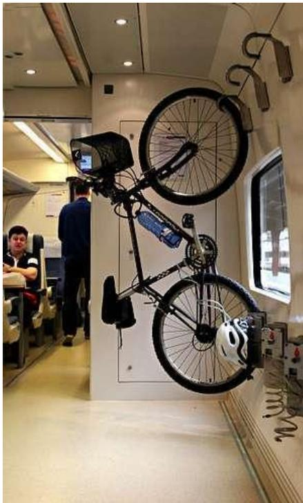
Imagen 118. Portabicicletas de gancho. Al no estar a nivel de suelo, hay que levantar la bicicleta, supone una desventaja para la comodidad del usuario, 2011
