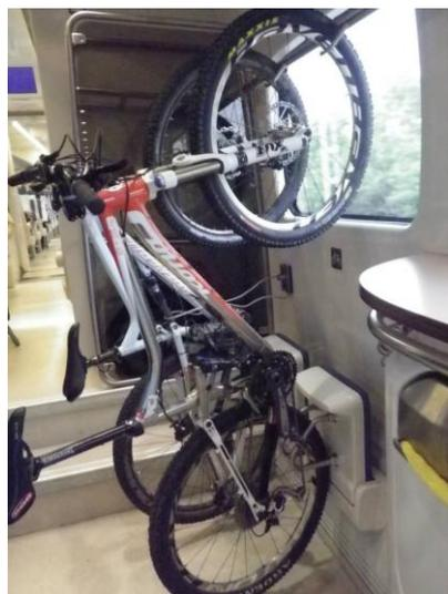
*Imagen 101. Correcta colocación y disposición de las bicicletas en el vagón, 2012*
