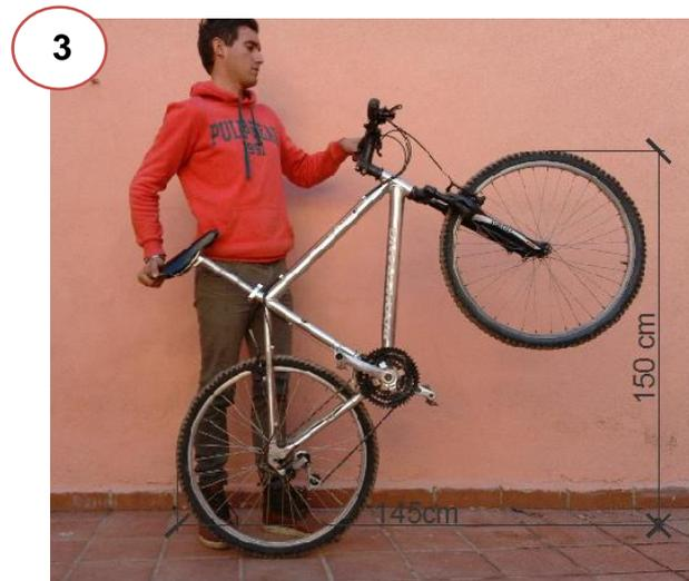
Imagen 190. Inclinación de la bicicleta a 45° aproximadamente para su correcta colocación.
