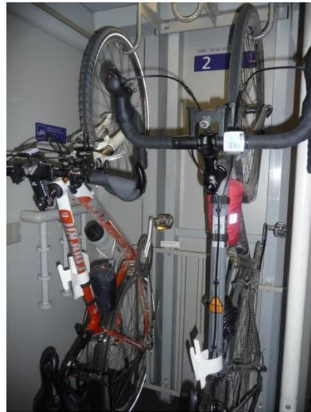
Imagen 117. Portabicicletas de gancho en el que se introduce la rueda a través de los radios. Se necesita anclar la rueda trasera para evitar la oscilación de estas, 2012
