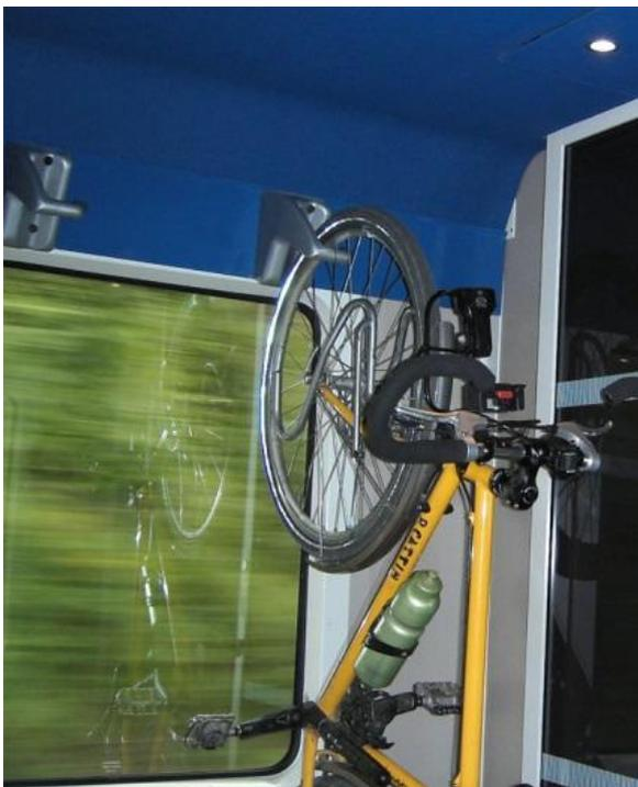
*Imagen 110. Enganche de mancuerna con sujeción de rueda delantera. Un hándicap es que el pedal puede romper el cristal de la ventana, 2013*
