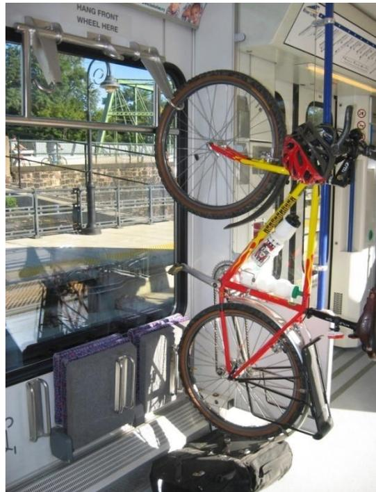
Imagen 119. Portabicicletas de gancho con sujeción de rueda delantera. La rueda trasera se sujeta gracias al asiento cuando está plegado ya que lleva unas guías para esta, 2013
