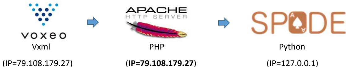
Fig. 3.14. Configuración de los IPs para la Interacción entre Voxeo, Apache y SPADE
