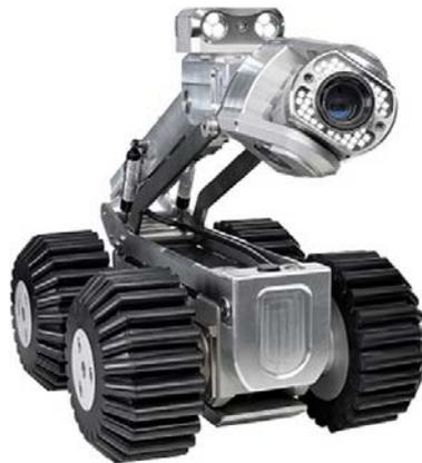
**Fig. 2.15.** Robot con la configuración de Ackerman
