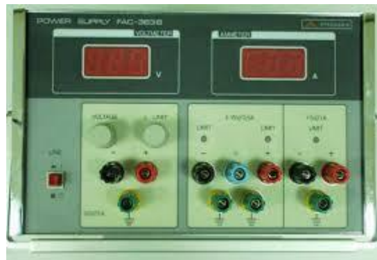
Figura 35: fuente de alimentación simétrica Promax FAC-363B
