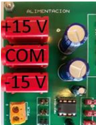
Figura A2.4: Conectores banana de alimentación
