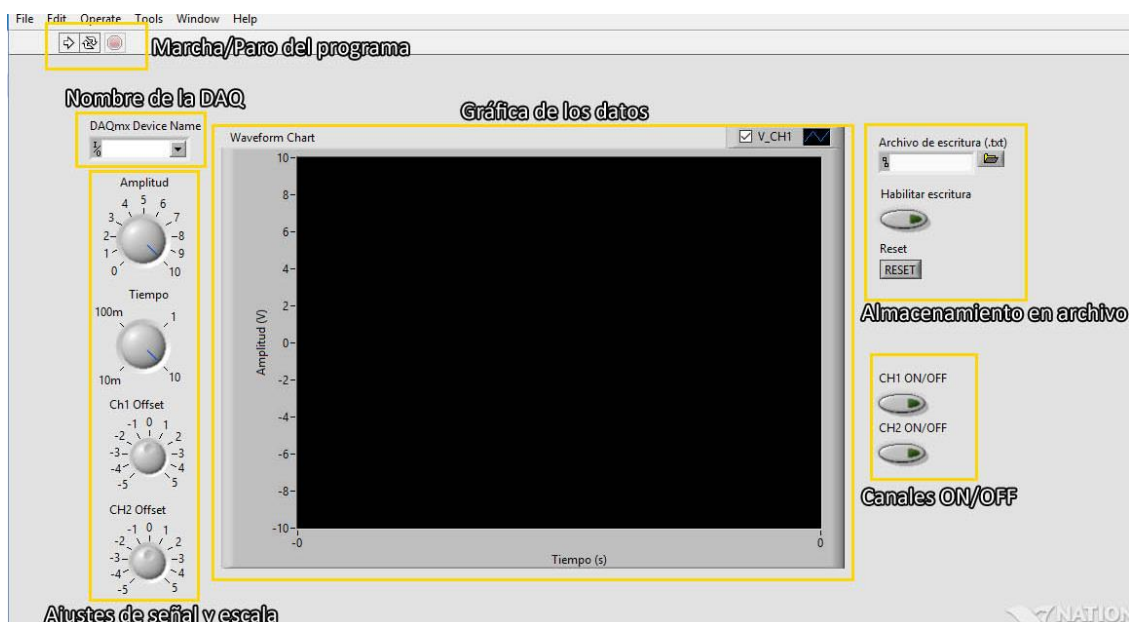
Figura A5.1: Ventana de la interfaz gráfica para el usuario de OsciloscopioVirtual.exe
