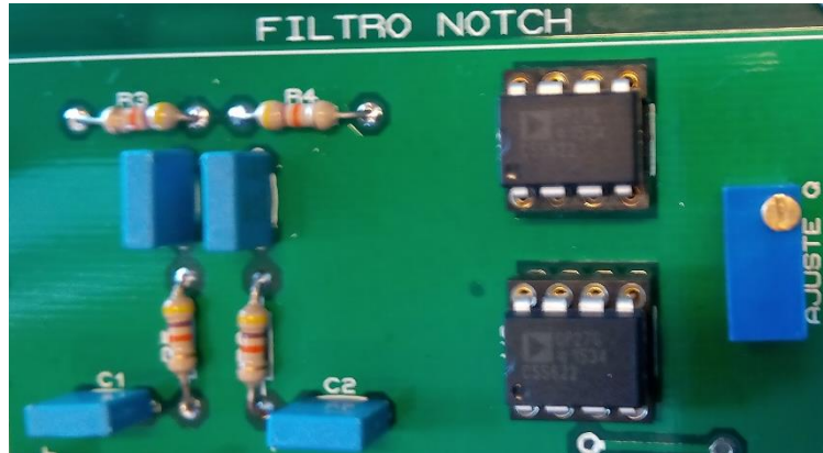
A2.11: Posición del potenciómetro de ajuste de ancho de banda
