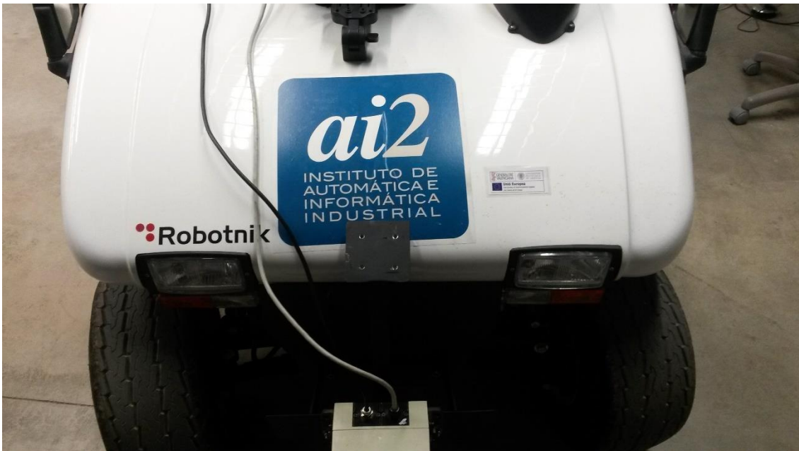
Fig.54. Acople del sensor en el frontal del RBCAR
