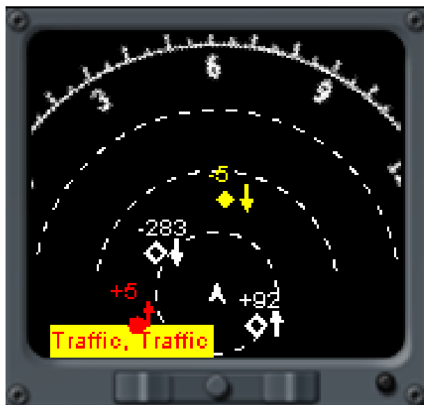
Figura 3.33: Ilustración de tráfico con riesgo de colisión en el TCAS
