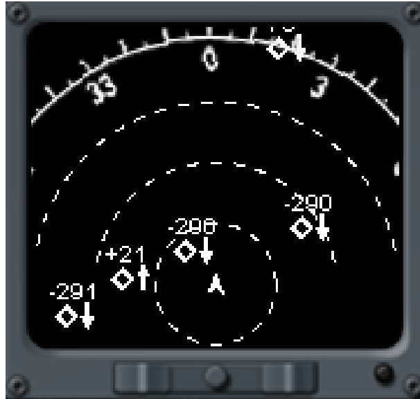
Figura 3.31: Ilustración de tráfico sin riesgo en el TCAS
