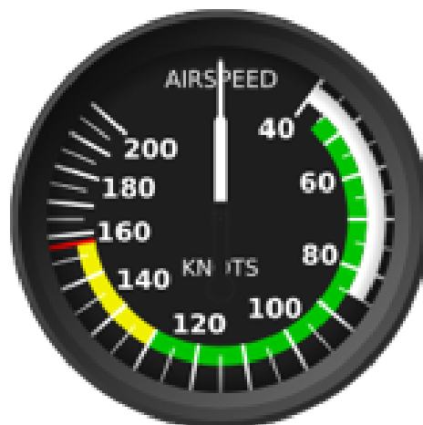
Figura 3.14: Rangos de velocidad del Airspeed Indicator (ASI)
