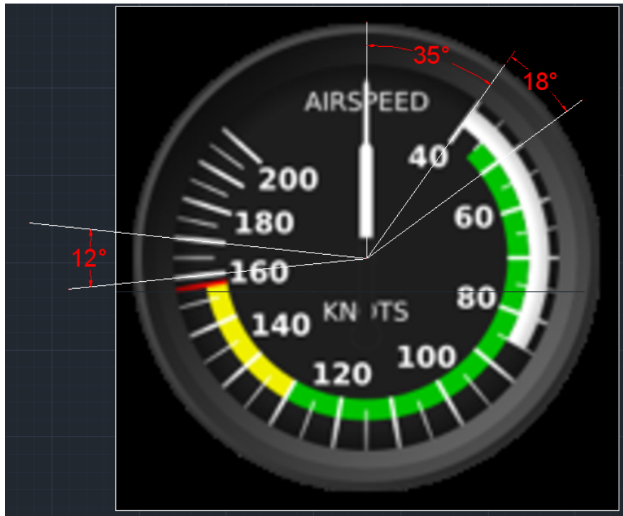
Figura 3.15: Obtención de las escalas del Airspeed Indicator mediante Autocad®
