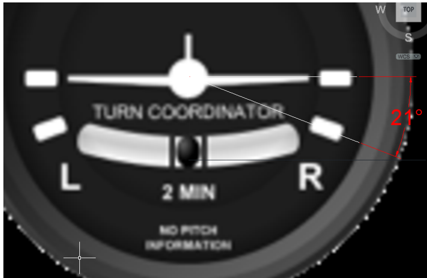
Figura 3.23: Obtención de la escala del indicador de ratio de giro mediante Autocad®
