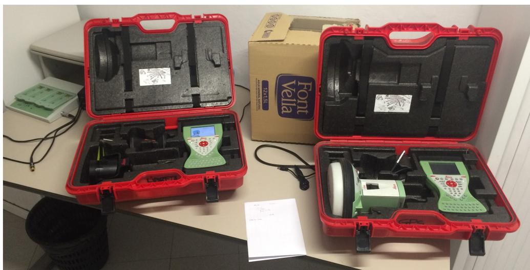
Ilustración 11: Estación total (izquierda) y equipo GNSS (derecha)
