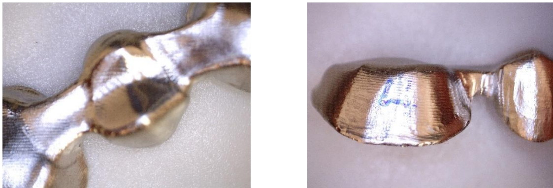
Figura 33. Imágenes en perfil y planta de las piezas fabricadas mediante fresado para observar aspectos físicos de las mismas.
