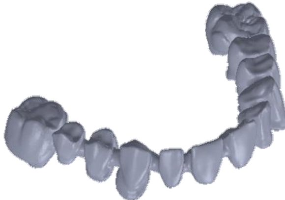
Figura 44. Arco dental completo regenerado en Solidworks.
