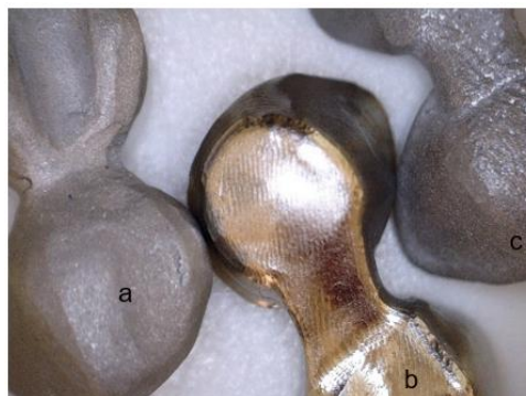
Figura 6. (a) Puente de Cr-Co obtenido por colada, (b) por fresado y (c) por sinterizado selectivo por láser.
