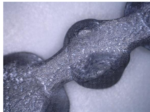
Figura 34. Imágenes en perfil y planta de las piezas fabricadas mediante sinterizado para observar aspectos físicos de las mismas.
