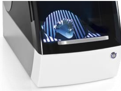
Figura 7. Luz blanca estructurada utilizada por el escáner para hacer la recolección de datos.
