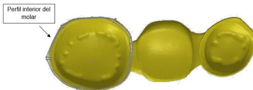
Figura 14. Perfil del marginal fit del modelo digital original.
