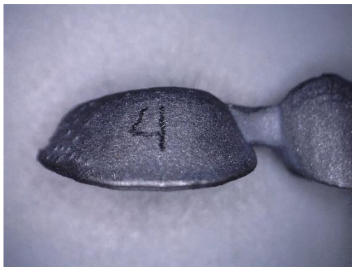
Figura 34. Imágenes en perfil y planta de las piezas fabricadas mediante sinterizado para observar aspectos físicos de las mismas.
