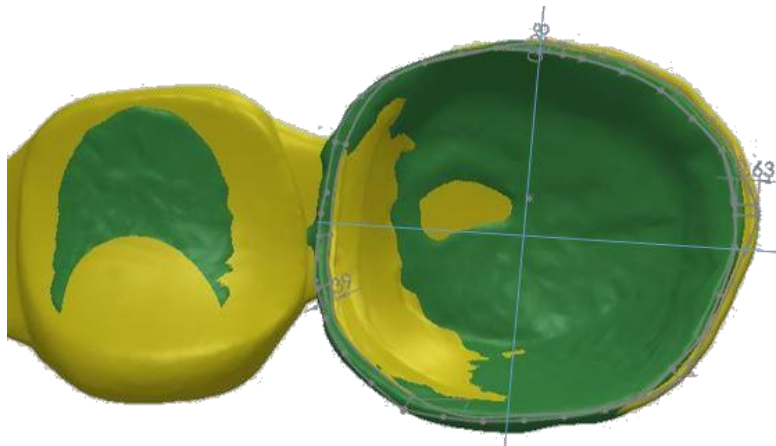
Figura 20. Algunas desviaciones máximas y mínimas en la comparación entre el modelo digital original y el modelo #1 fabricado por mecanizado CNC.
