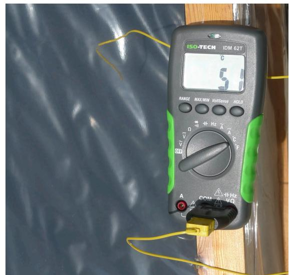
Figura 98. Medida del calor dentro del colector
