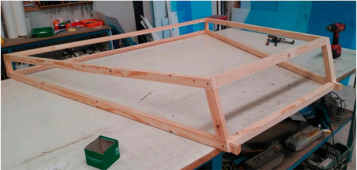
Figura 172. Montaje del colector
