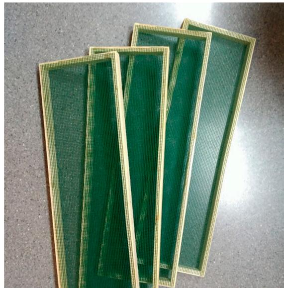
*Figura 186. Colocación de la rejilla en las bandejas*
