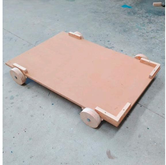
*Figura 179. Montaje de las ruedas y aspecto final del carro con las escuadras colocadas*
