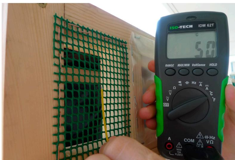
Figura 239. 50 °C alcanzados en la salida del aire
