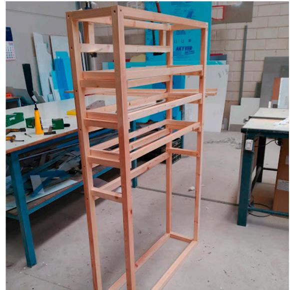
Figura 160. Estructura de la cámara de secado con bandejas
