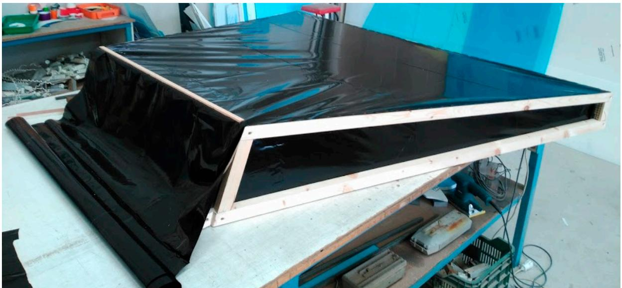
*Figura 184. Parte inferior del colector forrada con plástico negro*
