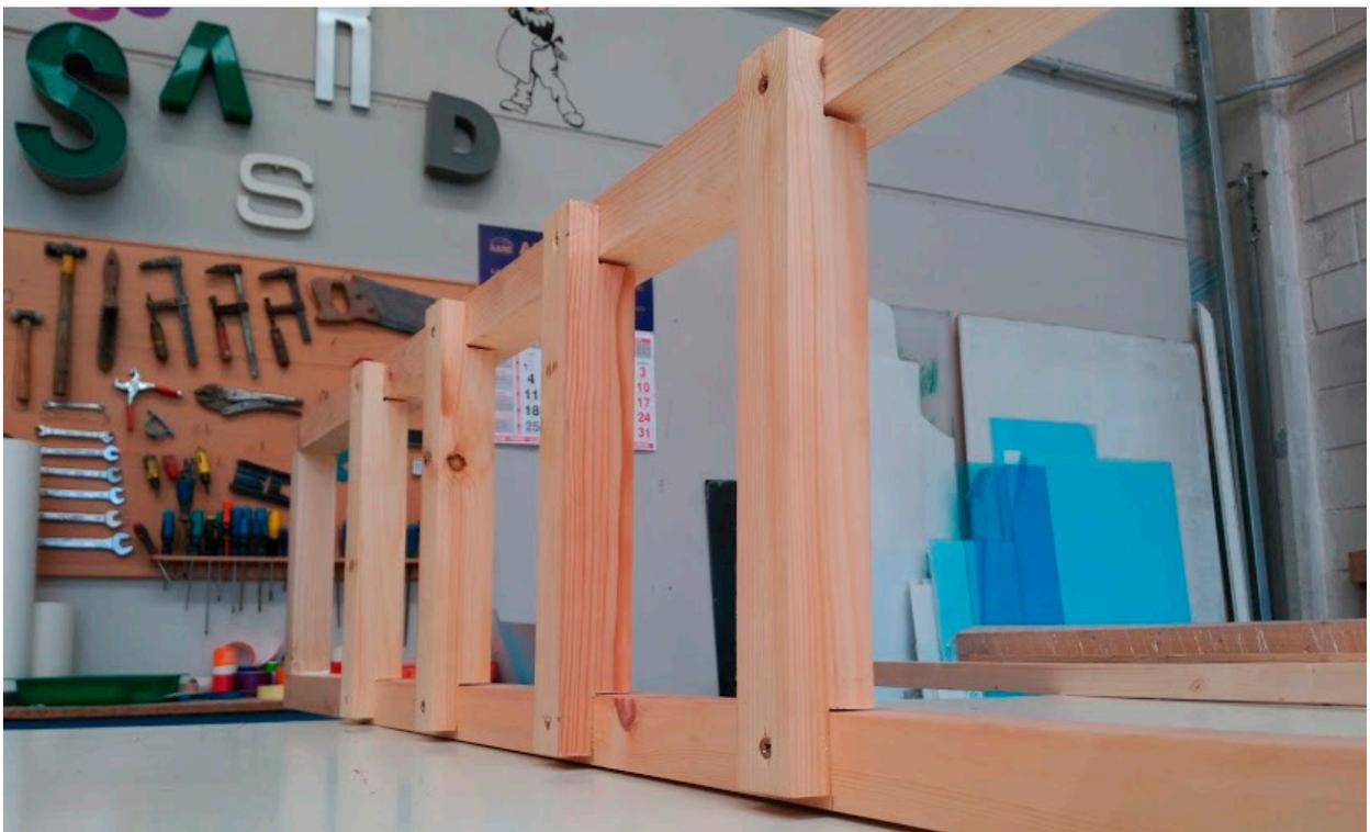
Figura 157. Lateral de la estructura con los soportes de las bandejas colocados
