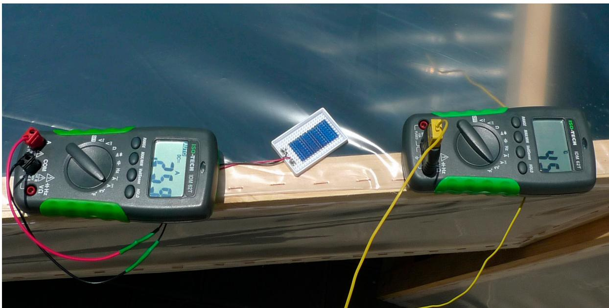
Figura 237. Temperatura dentro del colector y medida del potencial eléctrico
