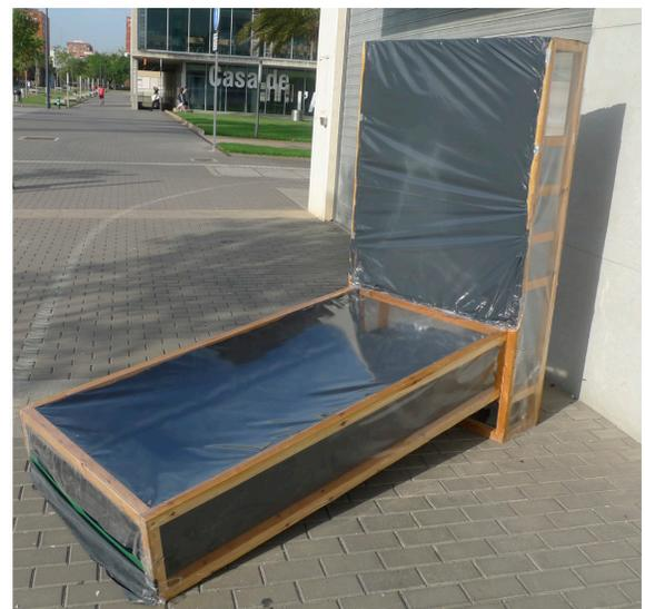
Figura 82. Deshidratador montado
