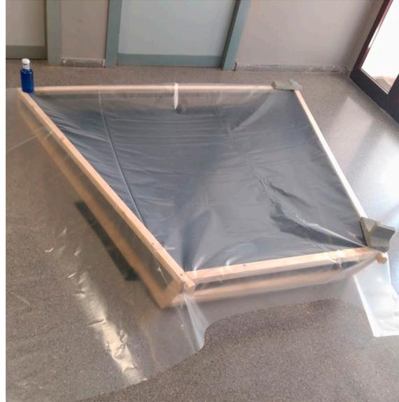
*Figura 185. Forrado del colector con plástico transparente*
