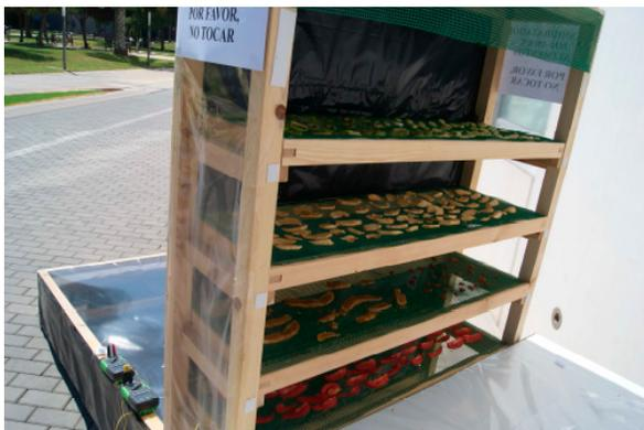
Figura 46. Vista trasera del deshidratador de alimentos del Grupo de Investigación en Energía Solar
