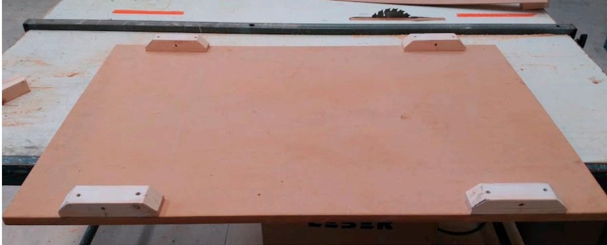
Figura 177. Superficie del carro con los topes para los ejes de la ruedas
