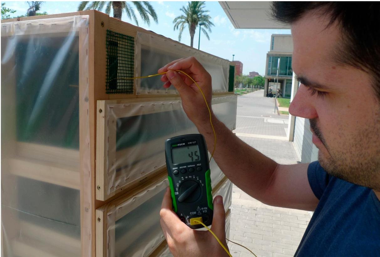
Figura 238. Temperatura en la salida del aire
