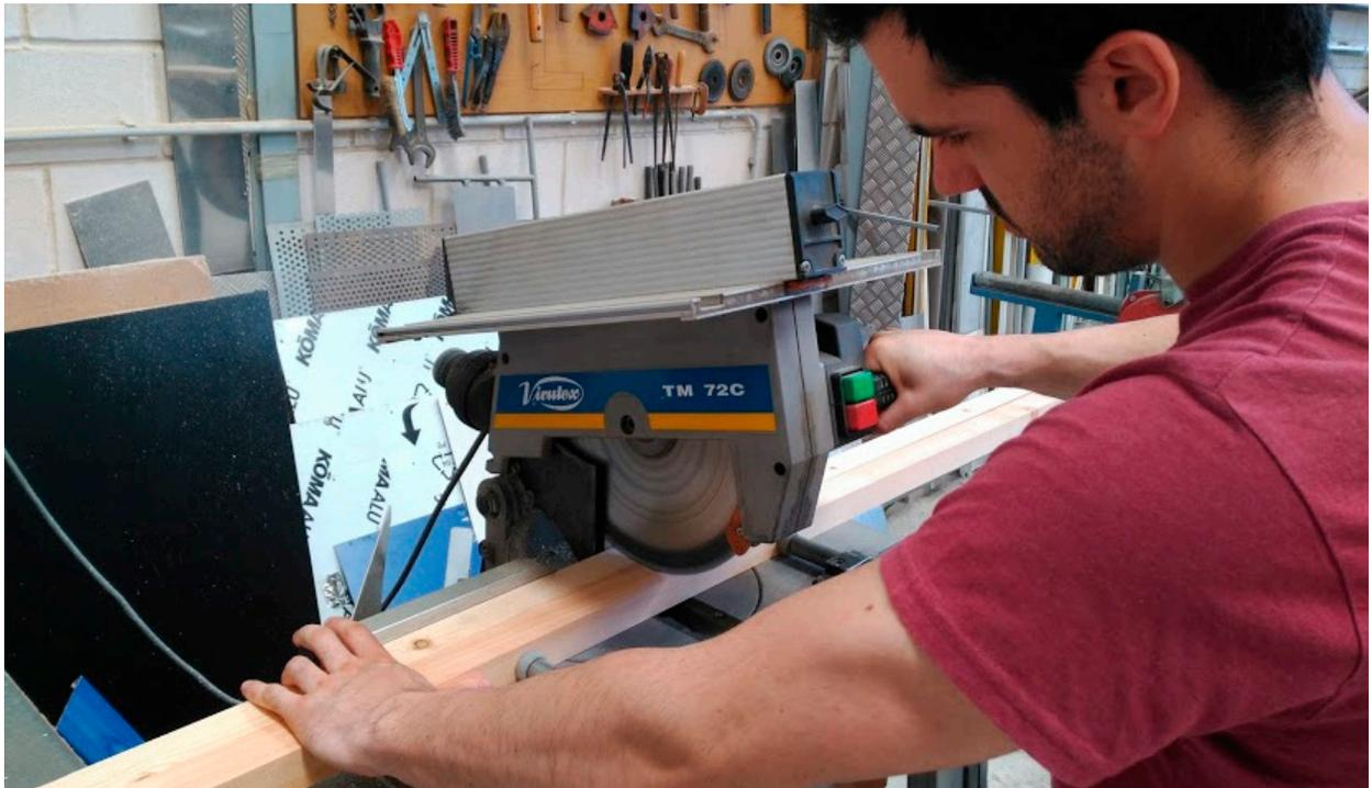
*Figura 151. Corte de los listones de madera con la tronadora*
