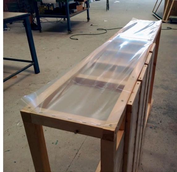
*Figura 181. Forrado de la estructura con plástico transparente*
