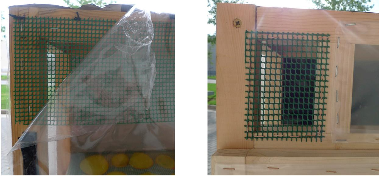
Figura 190. Orificio de salida del aire caliente
