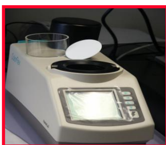
Figura 10. Colorímetro (HunterLab) utilizado para medir el color de los frutos.
