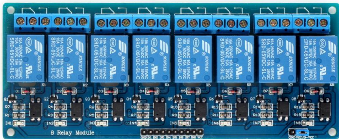
Figura 4.4: Módulo de relés para iluminación
