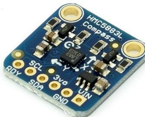
Figura 68. Magnetómetro marca Compass de tres ejes HMC5883L.
