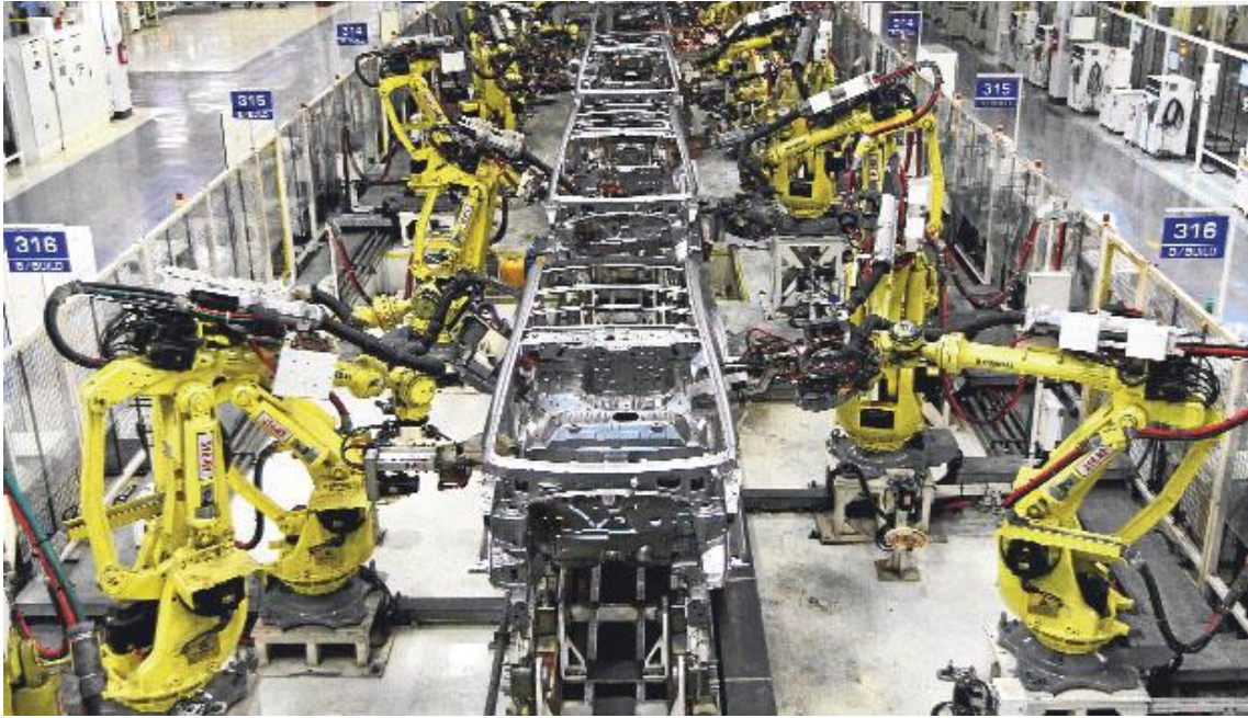
Figura 9. Cadena de montaje en la industria automovilística Ford, Almussafes, Valencia.
