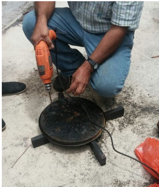
Figura 24: Perforación de la tapadera
