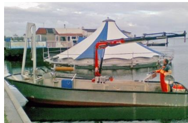
Figura 2.7. Grúa sobre embarcación
