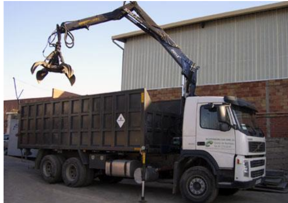
Figura 2.5. Grúa con pulpo
