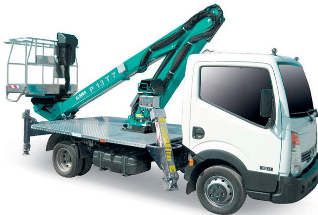
Figura 2.4. Grúa con cesta
