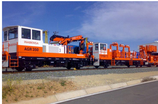
Figura 2.8. Grúa sobre ferrocarril
