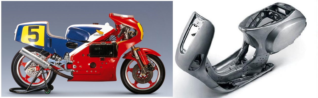
Figura 32 NR 500 y Vespa con chasis monocasco
