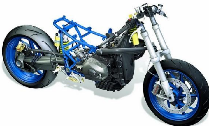
Figura 29 Bmw HP2 con motor estructural
