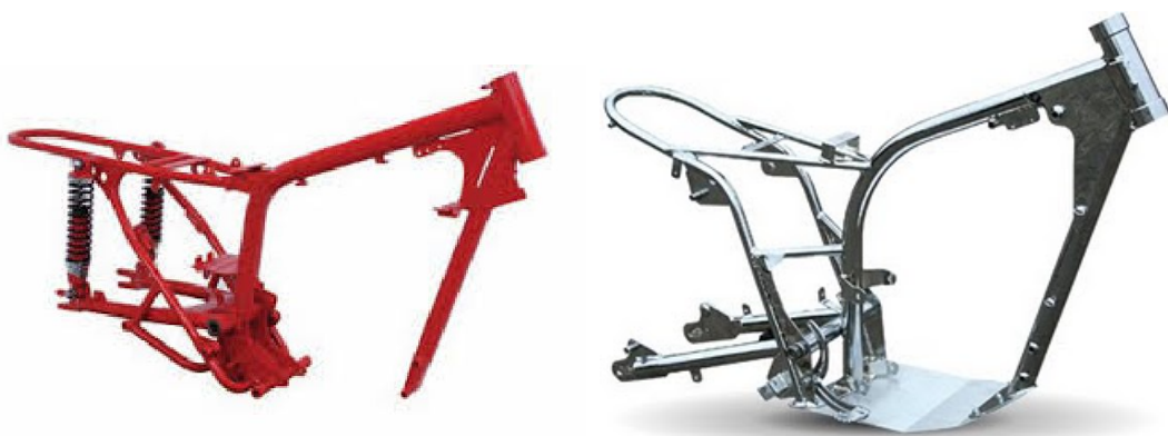
Figura 20 Chasis cuna simple interrumpido y chasis cuna simple desdoblado
