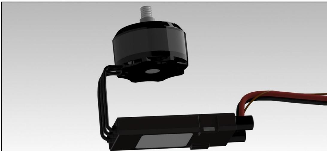
**Figura 36.** Arriba el modelado 3D del sistema de propulsión E800 y abajo su conexión.
