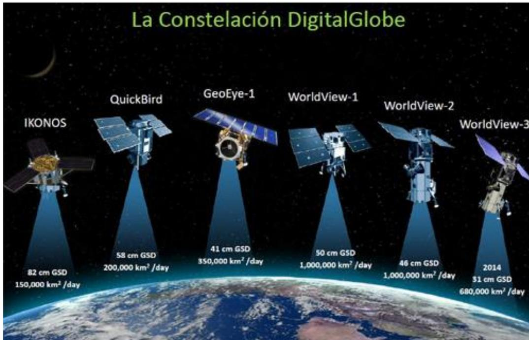
Figura 7. Satélites con sensores multispectrales. Recuperado de: <http://www.aeroterra.com/p-Geoeye.htm>
