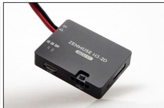
Figura 25. Controlador del *gimbal* GCU. Recuperado de [www.dji.com](http://www.dji.com)
