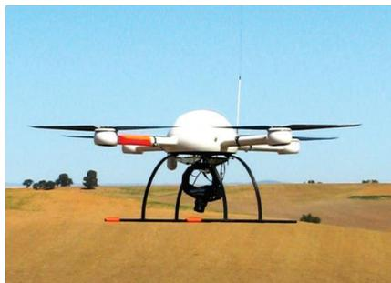
Figura 16. Plataforma Quadrocopter (Tores-Sánchez et al., 2013)
