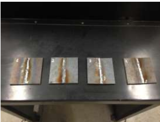
5.12. Tanda 1 de probetas soldadas (cara superior).
