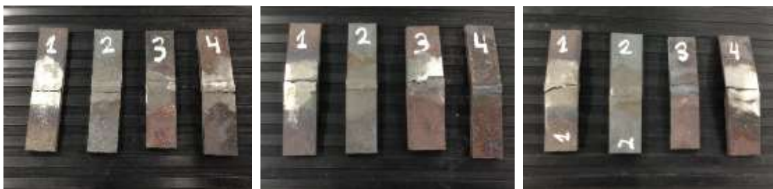
6.20. Probetas ensayadas a flexión.
