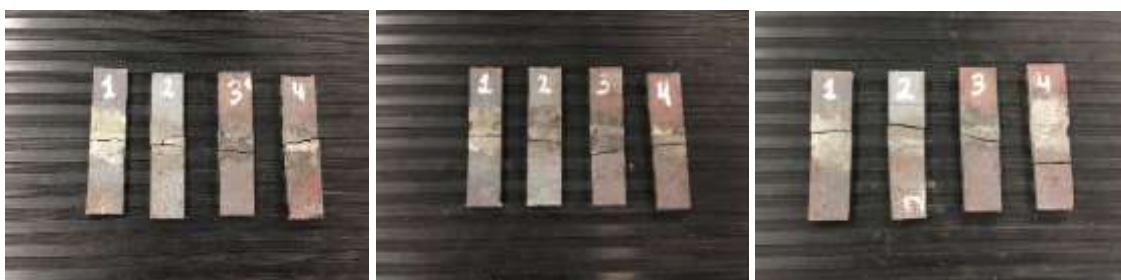
6.18. Probetas sometidas a tracción.
