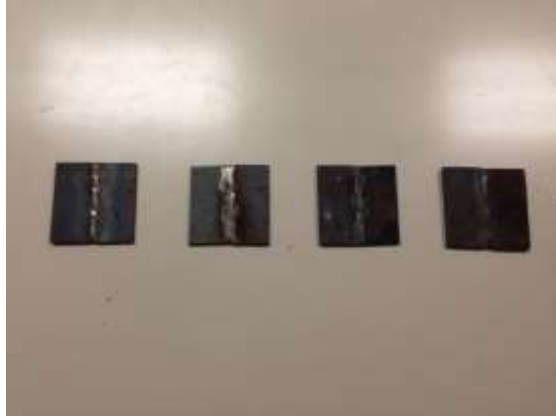
5.15. Tanda 2 de probetas soldadas (cara posterior).
