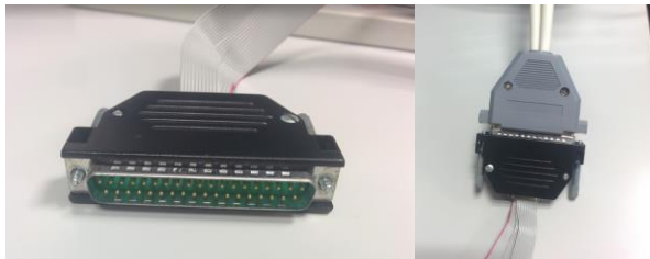
Ilustración 47. Conector y conexión DB37 de la maqueta al autómata
