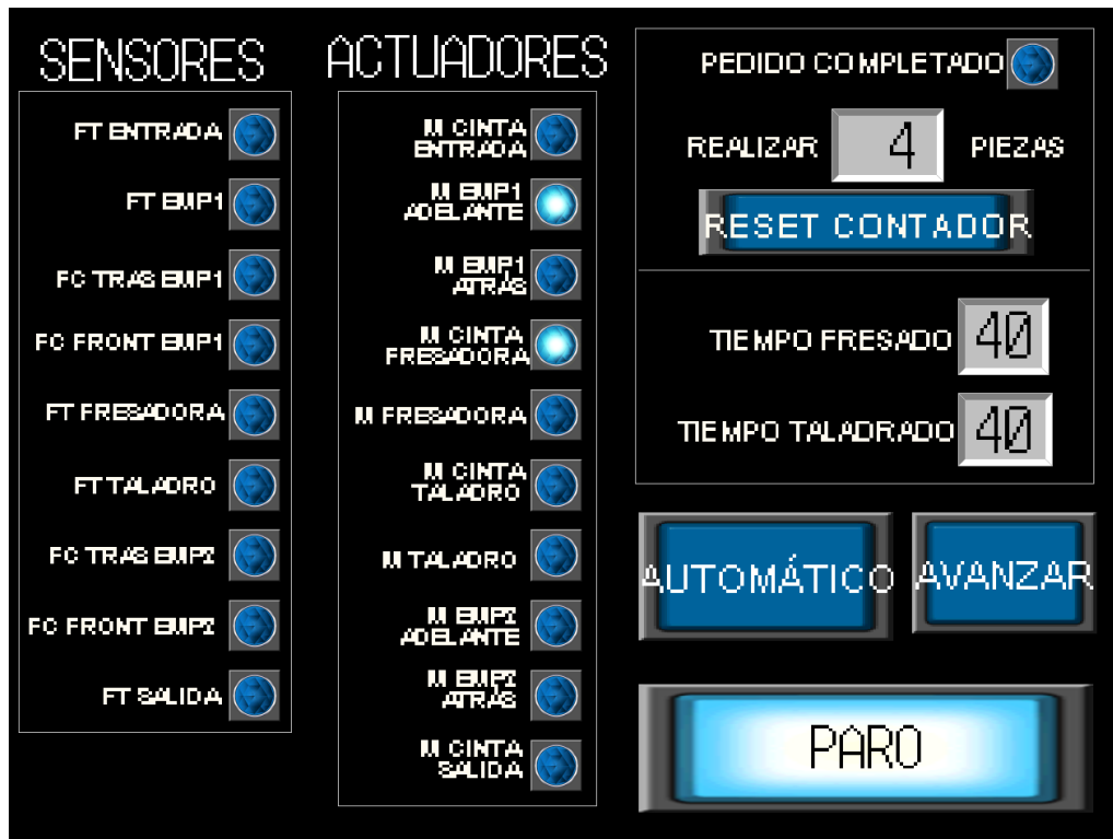
Ilustración 62. Empujador 1 saliendo y cinta estación de fresado en marcha. Pantalla táctil
