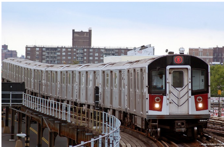
Figura 6: Composición de coches R142A. Sirven en el Metro de Nueva York, uno de los más importantes del mundo.
