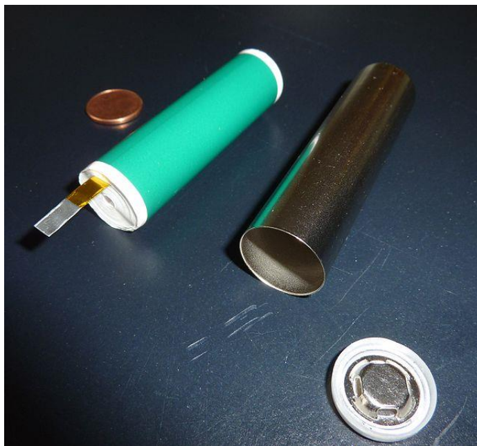
Figura 2.2.11 – Batería de fosfato de hierro-litio, antes de sellarla (A123 systems)
