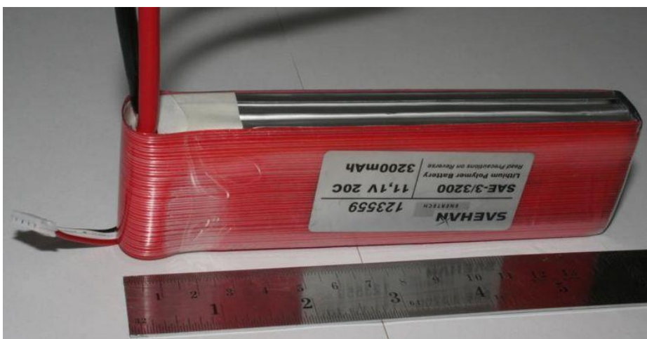
Figura 2.3. Batería de 3 elementos y 20C de descarga para un modelo radiocontrol
