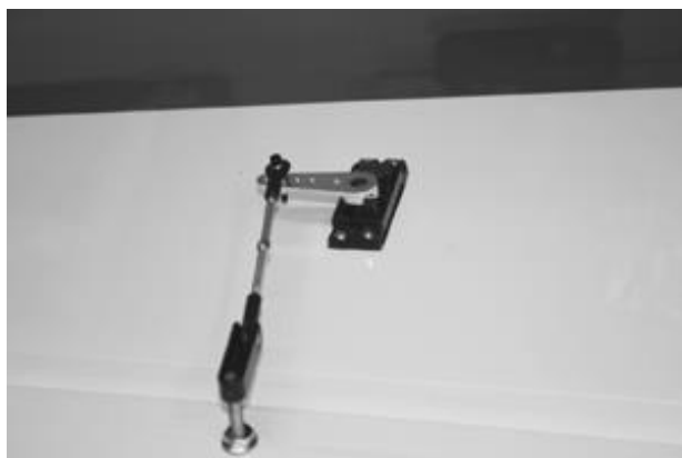
Figura 3.5 – Ajuste del varillaje del servo con el brazo.
