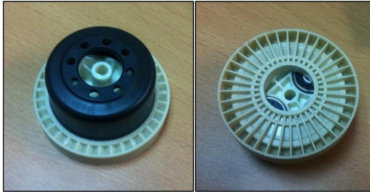
**Figura 11:** Harmonic Drive. Vista superior en la parte izq. Vista inferior en la parte dcha.
