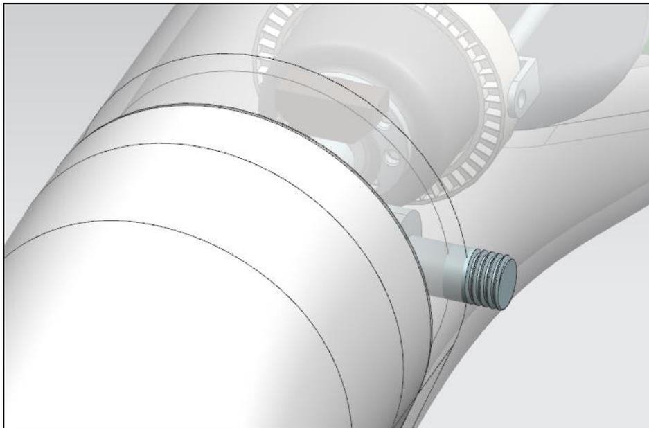
*Figura 27: Detalle del eje de unión entre brazo-chaleco.*
