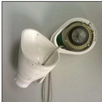
**Figura 45:** Ensamble e instalación del cableado.
