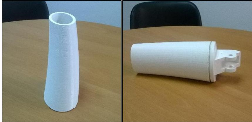
*Figura 9: Modelo final impreso de la pieza antebrazo y conjunto codo-antebrazo.*
