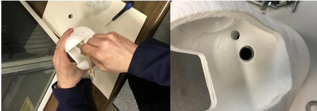
*Figura 39: Aplicación de acetona en las piezas impresas.*
