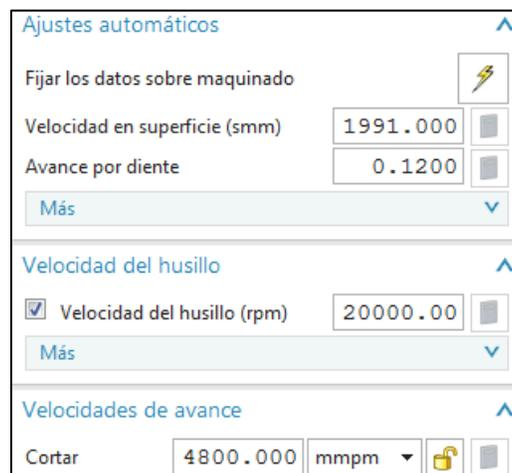
**Figura 61:** Configuración automática de avances y velocidades en la interface de NX.
