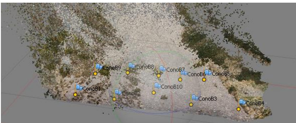
Ilustración 53. Nube de puntos del chunk 1 de la zona B del Puente Cervera. 96 imágenes 736435 puntos.
