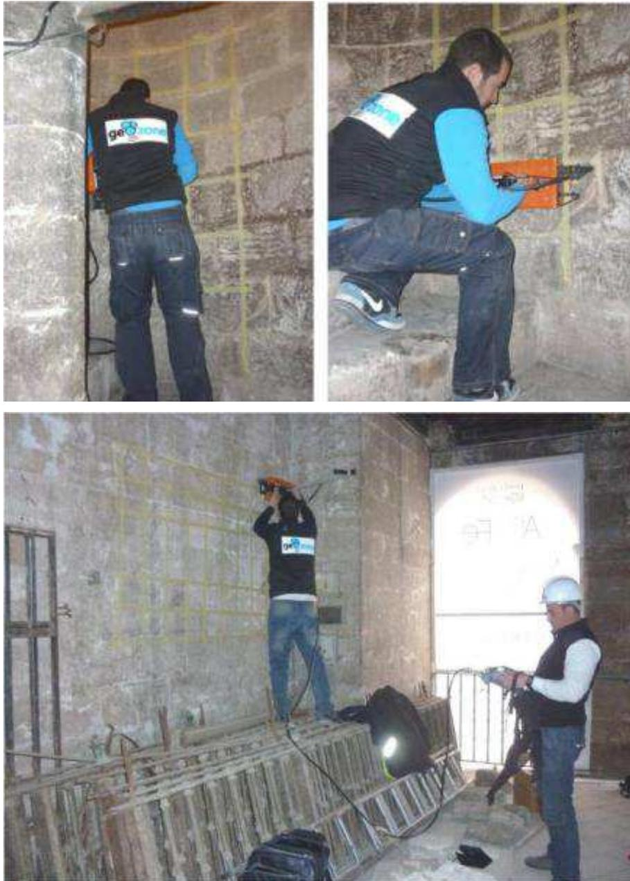
**Fig. 5. 15.10** Ensayo de georadar en la zona de la escalera y en el muro del transepto.
