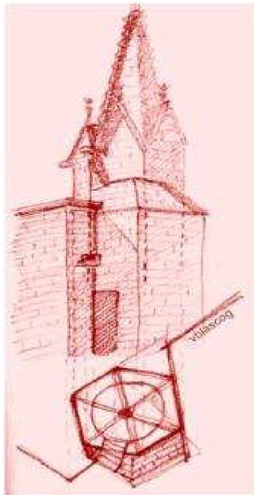
Fig. 6. 15.4 Hipótesis del autor. Estudio del cambio de sección de los muros de la escalera en el remate.
