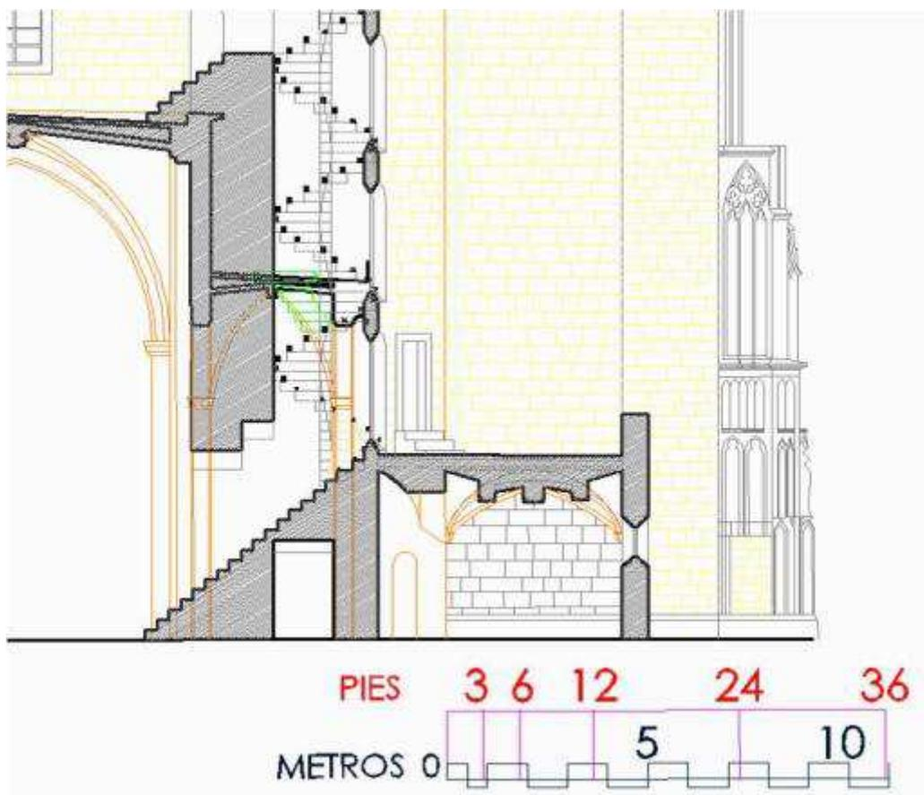
Fig. 5. 15.1 Sección por Sacristía Nueva. Construcción de la escalera de caracol. Detalle.
