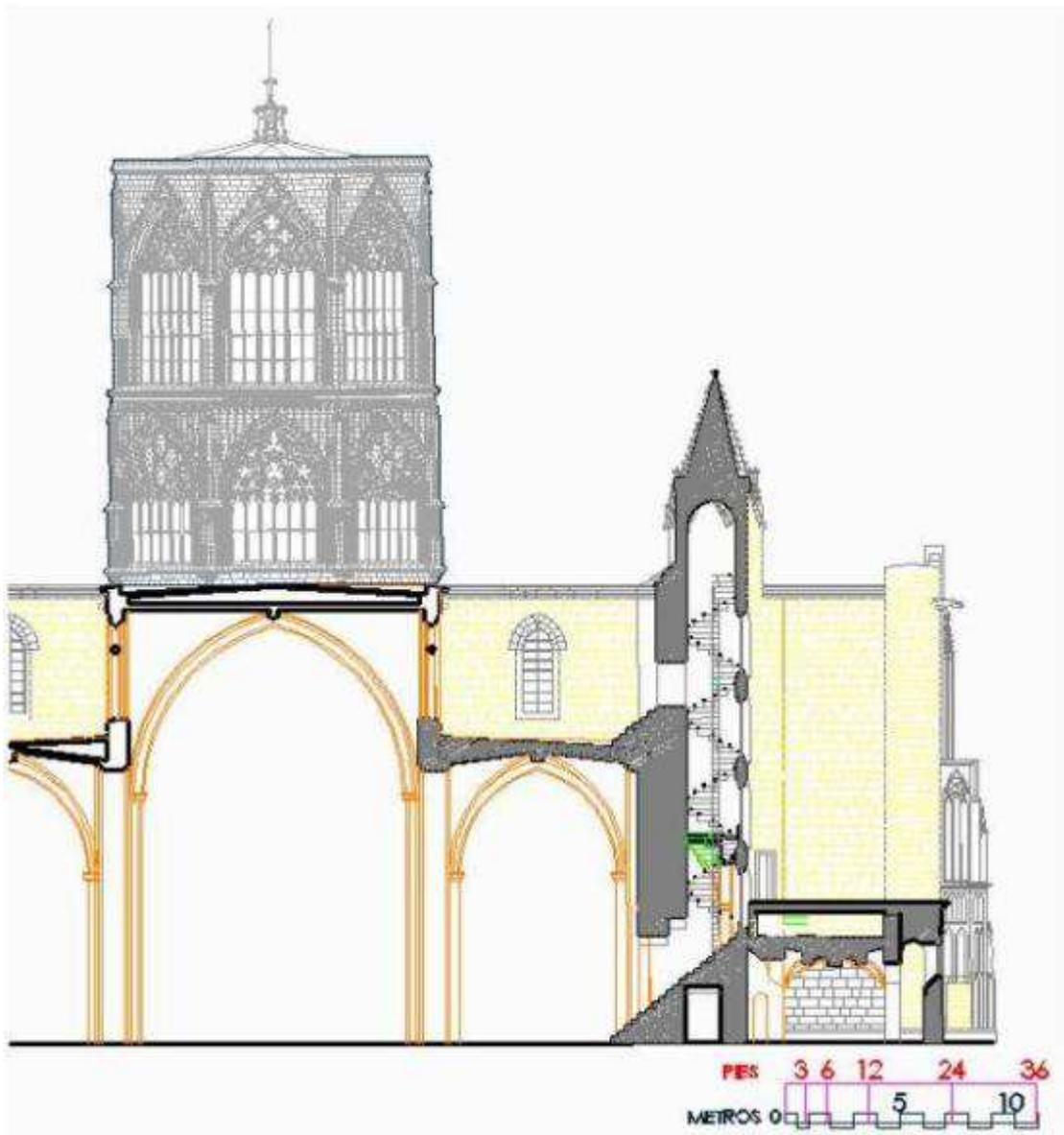
Fig. 9. 15.4 Sección por Sacristía Nueva. Ampliación previa a las galerías. Se sube el nivel de la terraza y el de la puerta de salida a la misma, ya de factura renacentista.
