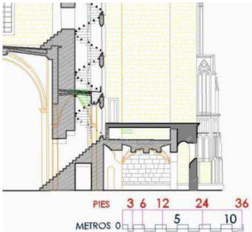
Fig. 11. 15.4 Sección por tramo recto de la escalera original y por Sacristía Nueva. Ampliación previa a las galerías. Detalle. Obsérvese la terraza superpuesta a la original.
