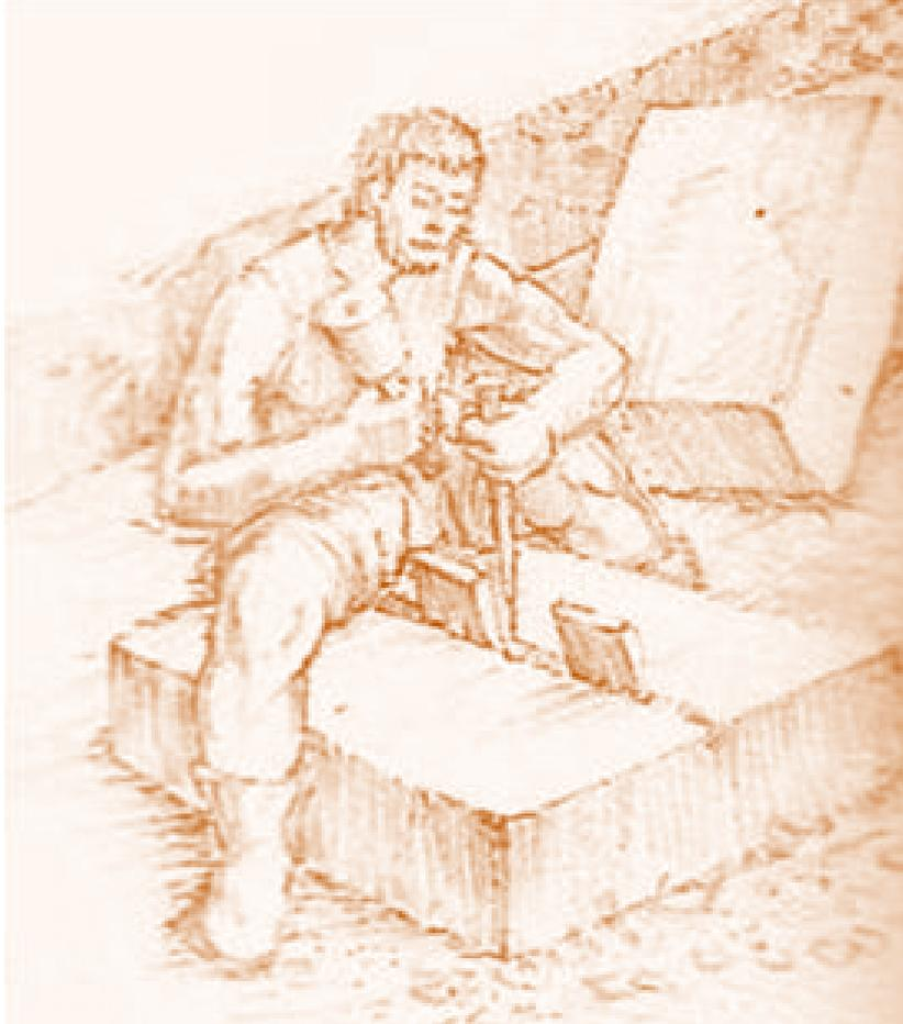
**Fig. 4. 11.1** “*Pedrapiquer*” despiezando un bloque de piedra
