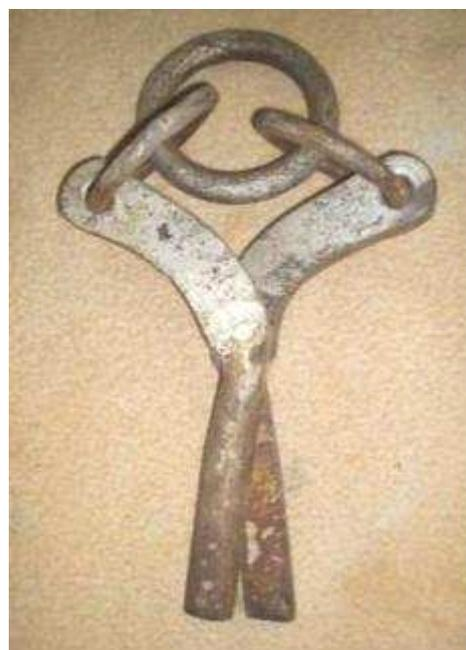
Fig. 26. 17.9 Castañuelas utilizadas para la elevación de sillares.<sup>799</sup>
