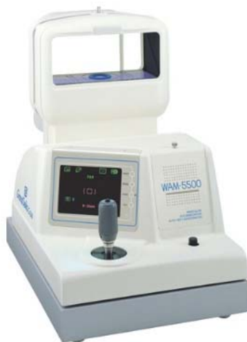
Figura 8. Autorrefractómetro de campo abierto WAM-5500 utilizado en este trabajo de investigación para llevar a cabo las medidas de error relativo periférico.
