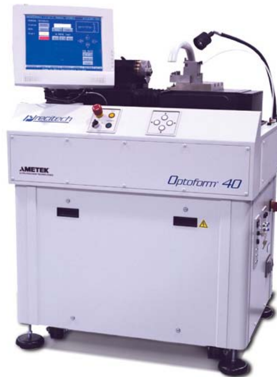
Figura 6. Imagen del torno Optoform 40 empleado en la fabricación de las LCs objeto de estudio.
