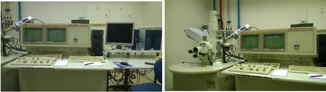
Ilustración 11 Microscopio electrónico de barrido
