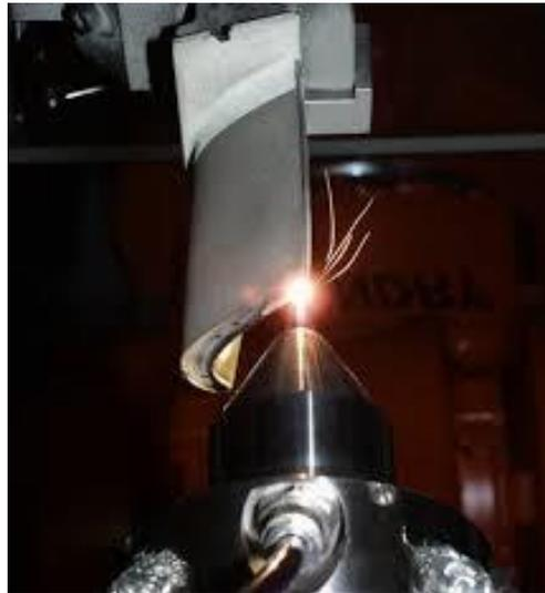
*Ilustración 2 Modificación superficial mediante Láser cladding sobre álabes turbina*
