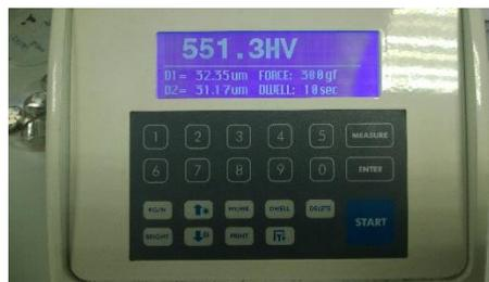
*Ilustración 20 Microdurómetro*
