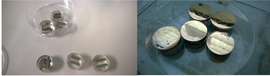
*Ilustración 13 Muestras ya embutidas. A la derecha se pueden ver con recubrimiento de oro para el SEM*
