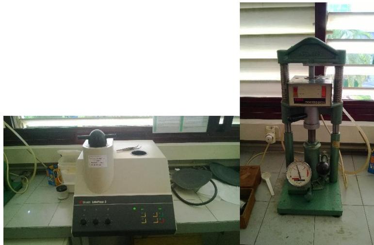
*Ilustración 7 Embutidora caliente-fría izda y embutidora manual dcha*
