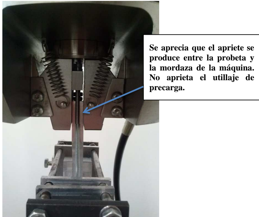
Figura 3.9: Probeta colocada en la máquina de ensayos para producir la carga alternante Bulk. Actúan momento, axil y carga alternante.
