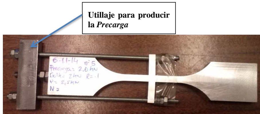
Figura 3.4: Probeta con el utilaje para ser precargada mediante la máquina servo hidráulica.
