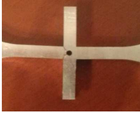
Figura 3.10b: Probeta tipo cruz con agujero. Ensayo tipo B.
