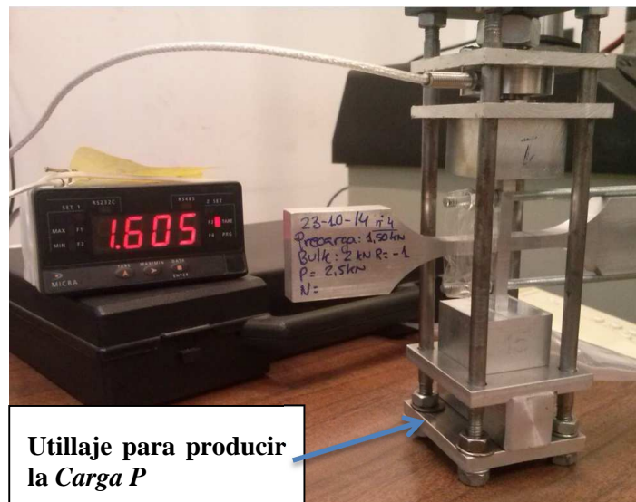
Figura 1.2.4: Utillaje para producir la Carga P y, por tanto, el Axil de compresión actuante.
