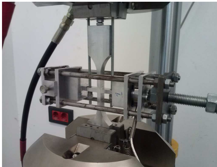
Figura 3.8: Probeta colocada en la máquina de ensayos para producir la carga alternante Bulk. Actúan momento, axil y carga alternante.
