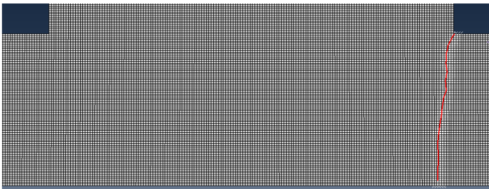
Figura 4.9: Propagación inicial hasta propagación final. Simulación ensayo 2
