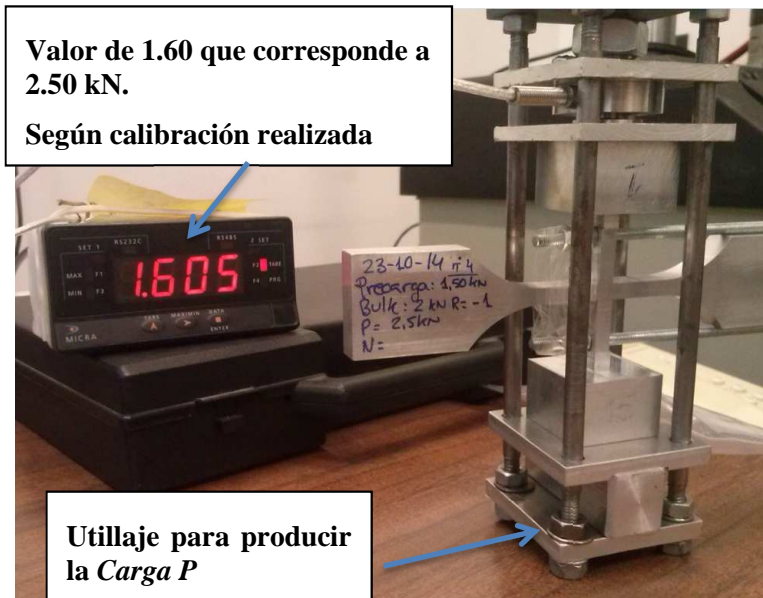
Figura 3.7: Probeta precargada y cargada con el utillaje diseñado para producir la carga constante P. Actúan momento y axil.
