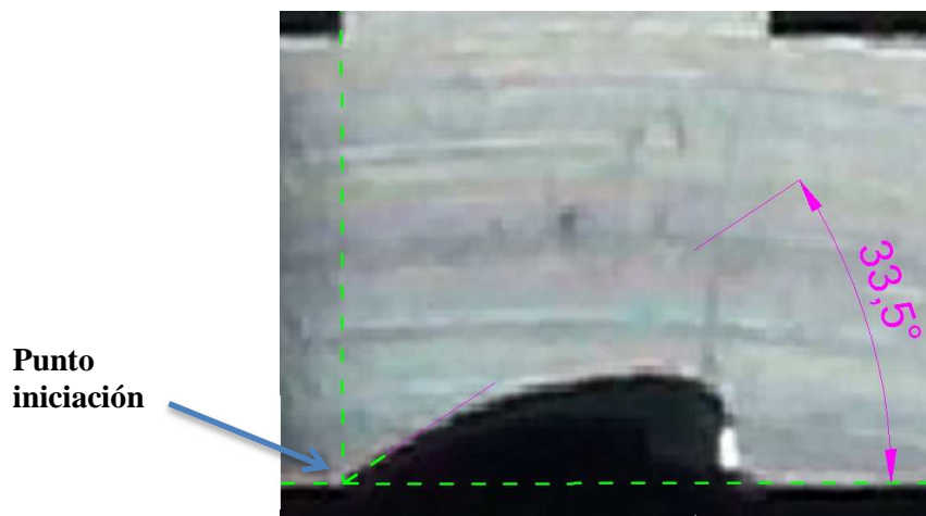
Figura 3.14b: Ángulo iniciación de grieta ensayo 1.
