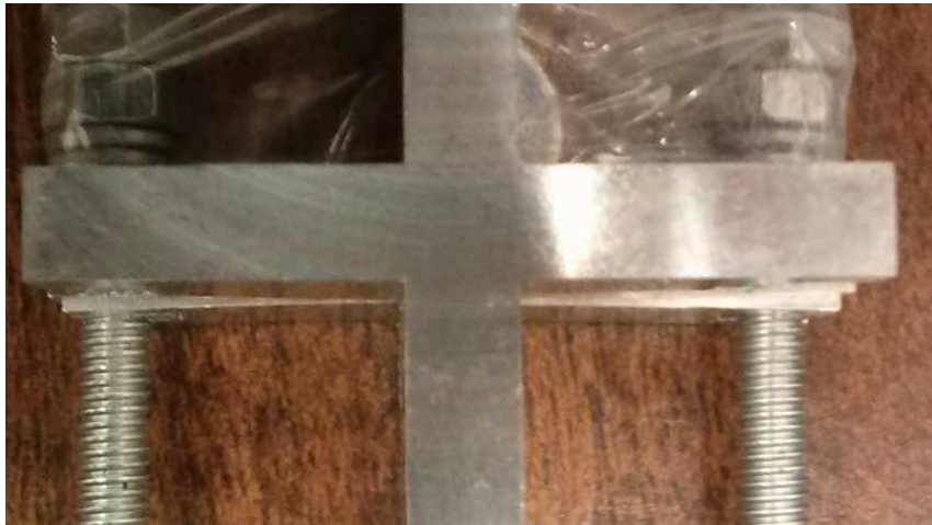
Figura 3.6: Probeta precargada comparada con probeta no precargada.
