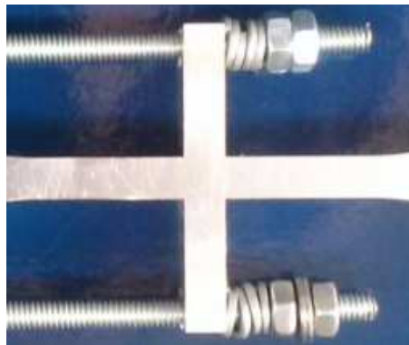
Figura 3.10a: Probeta tipo cruz sin agujero. Ensayo tipo A
