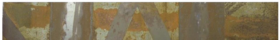
Huella de pegamento de barra (horizontal), celo, y cinta adhesiva sobre matriz de hierro.
