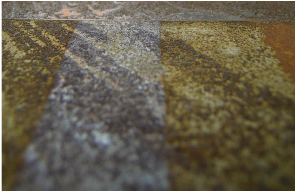
Huella de cera manley (trazos inclinados) sobre huella de cinta adhesiva (vertical y horizontal) sobre matriz de hierro.
