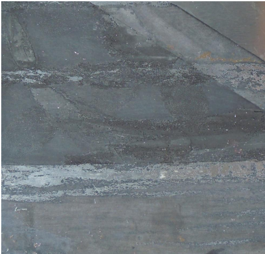
Huella de cera manley (horizontal) sobre pomada protectora (línea curva) y huellas de dedos entintados con protector labial sobre matriz de zinc.
