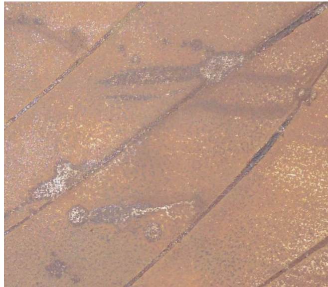
Huella de gotas y salpicado de preparado de azúcar sobre matriz de hierro.
