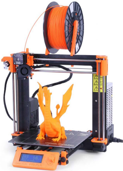
Fig. 21. Impresora 3D básica de inyección de polímeros. Podemos diferenciar fácilmente la bobina con el filamento y los ejes (X, Y, Z).
